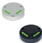
Version alignée, assemblage frontal non réglable ou réglable. Liquide de contraste vert transparent. Elles sont utilisées pour contrôler le positionnement horizontal de gabarits, de dispositifs, de machines, d'appareils et d'instruments. Diamètre: 62 mm
