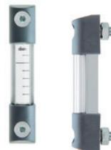
Extrémités de fixation en technopolymère. Protection en aluminium. Protection frontale transparente en polycarbonate. Voyant de niveau à colonne, tube transparent en verre borosilicate. Plaquette en aluminium laqué blanc. Vis, écrous et rondelles en acier INOX AISI 316. Joints d'étanchéité en silicone VQM rouge. Matière première adaptée au contact alimentaire (FDA CFR.21). Entraxes pour l'assemblage: 76 - 127 - 176 - 254 - 381 - 508 mm
