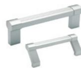
Barre à section ovale, aluminium anodisé, couleur naturelle. Supports latéraux en aluminium, disponibles sous forme inclinée, pliée ou droite. Assemblage à l'arrière au moyen de trous taraudés pour vis et rondelles en acier zingué. Entraxes pour l'assemblage: 200 - 300 - 500 mm
