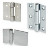
Goujon de rotation en acier INOX AISI 304. Assemblage au moyen de soudage, trous pour vis à tête cylindrique ou trous avec siège pour vis à tête fraisée plate. Angle de rotation max. 280° (-100° et +180° avec 0° = co-planéité des surfaces). Dimensions: 30 - 40 - 45 - 50 - 60 - 75 - 90 mm
