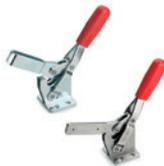
Douilles de support en acier trempé et rectifié. Poignée en polyuréthane, couleur rouge. Avec levier de serrage ouvert et deux rondelles pliées ou avec levier de serrage plein et bande pour soudage. Dimensions: 66,5 - 85 - 110,5 - 129 - 164 - 223 mm
