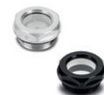
Avec ou sans réflecteur en technopolymère. Voyant en verre de sécurité ESG. Rondelle plate en FKM. Température maximale d'exercice en continu : 180 °C. Filetages métriques (pas 1.5): M14 - M16 - M20 - M26 - M27 - M33 - M40 - M42. Filetage GAZ: 1/4 - 3/8 - 1/2 - 3/4 - 1 - 1 1/4 - 1 1/2
