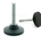
Base avec ou sans disque antiglisse en caoutchouc synthétique NBR. Tige filetée passante en acier zingué avec tête de réglage à six pans, anneau de retenue en acier bruni et rondelle plate d'appui en acier zingué. Écrou en acier zingué brillant sur demande. Bases Ø: 125 mm
