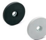
Insert en acier zingué avec trou passant lisse pour vis à tête fraisée. Revêtement antiglisse en élastomère thermoplastique (TPE), couleur noire ou blanche, dureté 80 Shore A. Aimant en Néodyme, Fer-Bore (NdFeB). Ø D = 43 ÷ 88 mm L = 6 ÷ 8,5 mm
