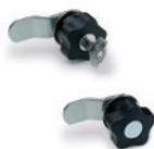
Stator et rotor en alliage de zinc moulé sous pression ; deux clés en laiton nickelé, extractibles en deux positions à 180° (serrure ouverte ou fermée). Ouverture à droite ou à gauche ; serrure à code différencié, unique ou sans serrure. Diamètre du petit volant: 40 mm
