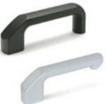
Aluminium, revêtement en résine époxy, couleur gris clair ou noire. Forme ouverte ou fermée pour un assemblage avec trous borgnes filetés ou forme ouverte frontale au moyen de trous passants pour vis à tête cylindrique. Entraxe pour l'assemblage: 128 mm
