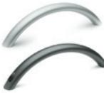
Barre à section ovale en aluminium avec finition naturelle, anodisé, ou avec revêtement en résine époxy, couleur noire. Assemblage à l'arrière au moyen de trous borgnes filetés ou assemblage frontal par des trous passants pour vis à tête cylindrique. Entraxes pour l'assemblage: 160 - 192 mm
