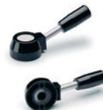
Corps central en technopolymère ; bras en acier chromé, poignée cylindrique en Duroplast ; plaquette frontale autocollante en aluminium. Trou lisse conformé avec face plate ou douille en acier bruni, trou alésé H7.
