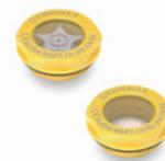
Voyant en technopolymère transparent. Avec ou sans plaquette. Rondelle plate en caoutchouc synthétique NBR. Conformes à la directive européenne ATEX 94/9/EU. Température maximale d'exercice en continu : 80 °C. Filetages GAZ: 3/8 - 1/2 - 3/4
