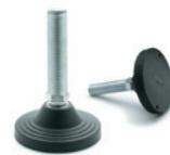
Base avec ou sans disque antiglisse en caoutchouc synthétique NBR. Tige filetée passante en acier zingué brillant avec tête de réglage à six pans. Fixation de la tige/base avec une vis et une rondelle en acier zingué. Écrou en acier zingué sur demande. Bases Ø: 125 mm
