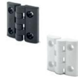
Goujon de rotation en technopolymère. Assemblage au moyen de trous passants pour vis à tête fraisée plate, tête cylindrique, tête hexagonale ou écrous. Angle de rotation: max 200° (-20 et +180 0° étant la condition de co-planéité des surfaces interconnectées). Dimensions: 40 - 49 - 65 mm
