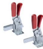
Douilles de support en acier trempé et rectifié. Poignée en polyuréthane, couleur rouge. Bandage levier anti-décrochage en polychlorure de vinyle (PVC). Avec levier de serrage ouvert et deux rondelles pliées ou avec levier de serrage plein et bande pour soudage. Dimensions: 85 - 110,5 mm
