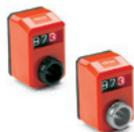
Boîtier et support de base en technopolymère ; voyant transparent en technopolymère. Douille en acier bruni ou en acier INOX AISI 303 avec trou Ø 10 alésé H7, fixation à l'arbre au moyen d'une vis de pression. Couleur orange, gris ou anthracite. Large gamme de lectures disponibles.
