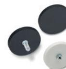
Insert fileté en acier zingué avec trou fileté ou goujon fileté. Revêtement antiglisse en élastomère thermoplastique (TPE), couleur noire ou blanche, dureté 80 Shore A. Aimant en néodyme, fer-bore (NdFeB). Ø D = 12 ÷ 88 mm L = 7 ÷ 8,5 mm
