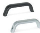
Couleur naturelle ou avec revêtement en résine époxy, couleur grise ou noire. Assemblage à l'arrière au moyen de trous borgnes filetés ou assemblage frontal par des trous passants pour vis à tête cylindrique à six pans creux. Entraxes pour l'assemblage: 120 - 140 mm
