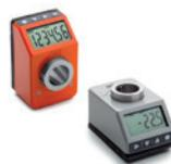
Couleur orange ou gris. Affichage LCD avec visualisation des valeurs en unités de mesure (mm, pouces ou degrés). Mesure absolue ou incrémentale, orientation de lecture. Paramètres de visualisation programmables par l'opérateur. Degré de protection IP65 ou IP67 selon EN 60529. Douille en acier INOX AISI 304 avec trou Ø 20 alésé H7.
