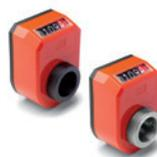
Boîtier et support de base en technopolymère ; voyant transparent en technopolymère. Douille en acier bruni ou en acier INOX AISI 303 avec trou Ø 20 alésé H7, fixation à l'arbre au moyen d'une vis de pression. Couleur orange, gris ou anthracite. Large gamme de lectures disponibles.
