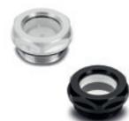
Avec ou sans réflecteur en technopolymère. Voyant en verre naturel. Rondelle plate en caoutchouc synthétique NBR. Température maximum d'exercice en continu: 100°C. Filetages métriques (pas 1.5): M14 - M16 - M20 - M26 - M27 - M33 - M40 - M42. Filetage GAZ: 1/4 - 3/8 - 1/2 - 3/4 - 1 - 1 1/4 - 1 1/2
