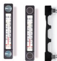
Protection en SUPER-technopolymère. Joints d'étanchéité à gradin pour l'étanchéité sur la paroi du réservoir et joint torique sous tête de la vis en caoutchouc synthétique NBR. HCZ/T-AR-PT : vis, écrous et rondelles en acier zingué. HCZ/T-AR-PT-VT : vis en SUPER-technopolymère, écrous et rondelles en acier INOX AISI 304. Thermomètre incorporé pour la lecture de la température du liquide. Entraxes pour l'assemblage: 76 - 127 - 254 mm
