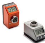
Couleur orange ou gris. Affichage LCD avec visualisation des valeurs en unités de mesure (mm, pouces ou degrés). Mesure absolue ou incrémentale, orientation de lecture. Paramètres de visualisation programmables par l'opérateur. Degré de protection IP65 ou IP67 selon EN 60529. Douille en acier INOX AISI 304 avec trou Ø 14 alésé H7.
