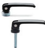
Levier en alliage de zinc moulé sous pression. Goujon de rotation et élément de serrage avec trou ou vis fileté(e) en acier zingué. Douille d'appui en acier zingué avec insert de contact en technopolymère ou entièrement en technopolymère. Dimensions: 44 - 63 - 82 - 101 mm
