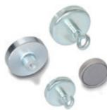
Enveloppe et insert fileté, en forme de crochet ou d'œillet en acier zingué ou acier INOX. Aimant en ferrite, en samarium-cobalt (SmCo) ou néodyme-fer-bore (NdFeB), blindé hautes performances. Ø D = 10 ÷ 125 mm L = 4.5 ÷ 26 mm
