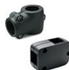
Vis à tête cylindrique M8 à six pans creux et écrous en acier zingué ou acier INOX AISI 304. Trous positionnement tube Ø: 42 - 48 - 50 - 60 - 45x45 mm
