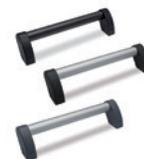
Tube en aluminium avec revêtement en résine époxy anodisé couleur naturelle. Supports latéraux en technopolymère. Assemblage frontal ou à l'arrière au moyen de trous passants pour vis à tête cylindrique, des vis à six pans creux ou écrous. Entraxes pour l'assemblage: 300 - 350 - 400 - 500 - 600 - 700 mm
