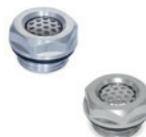
Filtere de protection en acier INOX AISI 304. Membrane transpirante en nylon non tissé. Rondelle plate en caoutchouc synthétique NBR. Température maximum d'exercice en continu: 100°C Filetage métrique : M20 - M28 - M33. Filetage GAZ: 1/2 - 3/4 - 1
