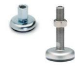
Rotule avec trou ou tige fileté. Disque antiglisse en caoutchouc synthétique NBR. Six pans creux à l'extrémité supérieure de la tige et faces plates fraisées sur la partie inférieure. Écrou en acier INOX AISI 304. Bases Ø: 50 - 60 - 80 - 100 - 120 mm
