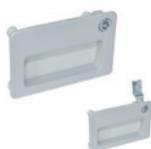
Poignée couleur noire ou grise. Exécutions standard: cannelure pour clé triangulaire, carrée 7x7 ou à deux ailettes, positionnée à droite ou gauche. Assemblage au moyen de 5 vis en acier zingué. Levier de fermeture GN 115 en acier zingué. Dimension: 128 mm, champs de régulation: de 13 à 75 mm
