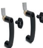
Rotor en technopolymère, bague d'arrêt et levier de fermeture en alliage de zinc. Douille en laiton, trou borgne fileté avec raccord triangulaire ou à deux ailettes pour clé. Rotation 90°. Entraxe de fixation : 117 mm
