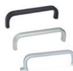
Barre à section ovale plate en aluminium couleur naturelle, avec revêtement en résine époxy, couleur argent ou noire. Assemblage postérieur par trous borgnes filetés. Entraxes pour l'assemblage: 120 - 160 - 180 - 200 - 250 - 300 - 350 - 400 mm
