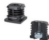
Ecrou DIN 934 en acier zingué brillant. Les deux parties du bouchon sont reliées entre elles par deux goujons qui sont logés dans des contre-sièges spéciaux. Dans la partie intérieure du bouchon il y a une cavité pour le logement d'un écrou hexagonal DIN 934. Filetages: M6 - M8 - M10 - M12 - M16
