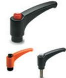
Bouton dans les couleurs Ergostyle, finition brillante. Élément en technopolymère avec douille en laiton ou acier INOX AISI 303, trou borgne fileté; tige fileté en acier zingué ou acier INOX AISI 303.
