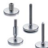
Rotule avec trou ou tige fileté. Base avec ou sans disque antiglisse en caoutchouc synthétique NBR. Vis avec tête de réglage à six pans, avec six pans creux et faces plates. Bases Ø: 80 - 100 - 120 mm
