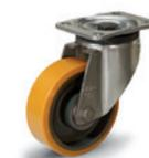
Moyeu avec roulements à billes. C'est une solution idéale pour les charges élevées et pour les déplacements de type continu. Support en tôle d'acier zingué, platine fixe ou pivotante, avec ou sans frein. Roue Ø: 100 - 125 - 150 - 200 mm
