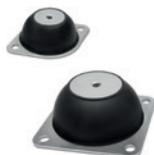
Flasque de fixation ovale ou carrée. Douille avec trou borgne fileté. Corps antivibratoire en caoutchouc naturel NR, dureté 40, 60 ±5 Shore A. Diamètres: 18 - 33 - 45 - 53 - 58 mm
