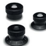
Neutre, index triangulaire ou graduation de précision, gravés au laser. Calotte de fermeture en technopolymère dans les couleurs standard. Douille en laiton, trou borgne lisse. Fixation au moyen d'une vis de pression transversale. Diamètres: 30 - 40 - 50 mm
