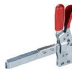
Douilles de support en acier trempé et rectifié. Poignée en polyuréthane, couleur rouge. Bandage levier anti-décrochage en polychlorure de vinyle (PVC). La rallonge spéciale du bras d'arrêt en facilite l'utilisation dans les gabarits de contrôle. Dimensions: 164 - 198 mm
