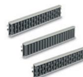
Profilé en aluminium anodisé. Support pour goujons et rouleaux en technopolymère. Goujons en acier INOX AISI 304. Avec rouleaux cylindriques ou façonnés, zone de contact sphérique ou cylindrique. Ils sont utilisés pour guider latéralement sur les bandes transporteuses les produits ayant une faible dimension verticale.
