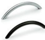
Barre à section ronde en acier chromé, avec un revêtement en résine époxy, couleur grise, noire ou en acier INOX AISI 303. Assemblage postérieur par trous borgnes filetés. Entraxes pour l'assemblage: 64 - 96 - 128 - 160 - 192 mm
