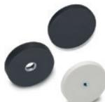
Insert en acier zingué avec trou fileté ou trou lisse. Revêtement antiglisse en élastomère thermoplastique (TPE), couleur noire ou blanche, dureté 80 Shore A. Aimant en néodyme, fer-bore (NdFeB). Ø D = 18 ÷ 88 mm L = 6 ÷ 8,5 mm
