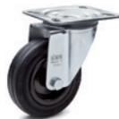
Support en tôle d'acier zingué, platine fixe ou pivotante (également avec trou passant central), avec ou sans frein. Se prêtent tout particulièrement pour les charges moyennes et légères et peuvent également être utilisées en extérieur, par exemple pour les chariots industriels de manutention. Roue Ø: 80 - 100 - 125 - 150 - 180 - 200 mm
