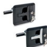
Poignée couleur noire ou grise. Exécutions standard: serrure à chiffage différencié ou unique. Assemblage au moyen de 4 vis en acier zingué co-moulées dans la base. Le basculement de la poignée dans son logement déplace axialement l'arbre avec le levier dans la direction du battant, jusqu'à la position de blocage. Dimension: 128 mm, champ de régulation: de 13 à 75 mm
