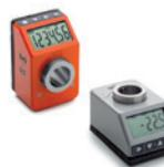
Couleur orange ou gris. Affichage LCD avec visualisation des valeurs en unités de mesure (mm, pouces ou degrés). Mesure absolue ou incrémentale, orientation de lecture. Paramètres de visualisation programmables par l'opérateur. Degré de protection IP65 ou IP67 selon EN 60529. Douille en acier INOX AISI 304 avec trou Ø 20 alésé H7.
