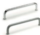
Barre à section ronde en acier chromé, bruni, acier INOX ou en aluminium avec une finition anodisée ou avec un revêtement en résine époxy. Assemblage postérieur par trous borgnes filetés. Entraxes pour l'assemblage: 64 - 88 - 100 - 120 - 125 - 160 - 180 - 200 - 235 - 250 - 300 mm
