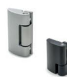
Goujon de rotation en acier INOX AISI 304. Assemblage au moyen de vis de fixation autotaraudeuses en acier INOX. Existe avec corps de co-planéité, avec corps surélevé, ouverture à gauche ou à droite. Angle de rotation max. 185° (-5° e +180° avec 0° = co-planéité des surfaces). Dimensions: 50 - 70 - 90 mm
