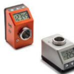
Couleur orange ou gris. Affichage LCD avec visualisation des valeurs en unités de mesure (mm, pouces ou degrés). Mesure absolue ou incrémentale, orientation de lecture. Paramètres de visualisation programmables par l'opérateur. Degré de protection IP65 ou IP67 selon EN 60529. Douille en acier INOX AISI 304 avec trou Ø 14 alésé H7.
