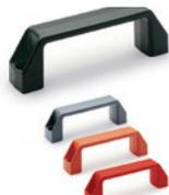
Disponibles en couleur noire, orange, grise, rouge et vert. Assemblage frontal au moyen de trous passants pour vis à tête cylindrique à six pans creux, vis à tête fraisée plate, vis à six pans creux ou écrous. Entraxes pour l'assemblage: 94 - 117 - 120 - 122 - 132 - 140 - 149 - 152 - 150 - 160 - 179 - 235 mm
