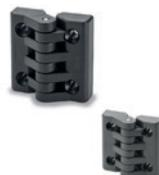
Goujon de rotation en acier INOX AISI 303. Assemblage au moyen de douilles en laiton nickelé, trou fileté ; tiges filetéés en acier nickelé ; alésage et trous oblongs (CFA-SL) passants pour vis à tête cylindrique. Angle de rotation max. 215° (-35° et +180° avec 0° = co-planéité des surfaces). Dimensions: 40 - 49 - 65 - 97 mm
