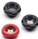
Voyant en technopolymère transparent. Avec ou sans plaquette. Rondelle plate en caoutchouc synthétique NBR. Température maximum d'exercice en continu: 100 °C. Filetages GAZ: 3/8 - 1/2 - 3/4 - 1 - 1 1/4 - 2
