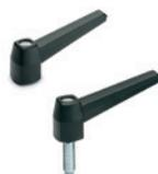
Douille en laiton, trou borgne fileté ou tige fileté en acier zingué, trou borgne cylindrique ou carré et armature en laiton avec demi-trou transversal pour le goupillage sur l'arbre. Dimensions: 42 - 63 - 80 - 100 mm
