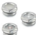
Voyant en technopolymère transparent. Rondelle plate en caoutchouc synthétique NBR. Température maximale d'exercice en continu : 110 °C. Voyant prismatique neutre ou avec petit cercle. Filetages métriques (pas 1.5): M20 - M26 - M27 - M33. Filetages GAZ: 1/2 - 3/4 - 1
