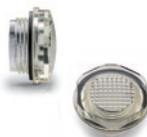
Une série continue de prismes donnent une lecture claire du niveau de l'huile par un effet de réfraction. Rondelle plate en caoutchouc synthétique NBR. Température maximum d'exercice en continu: 100°C Filetages GAZ: 1/2 - 3/4 - 1 - 1 1/4
