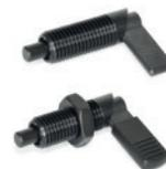
Corps fileté en acier bruni. Embout en acier tourné et nitruré. Levier en acier bruni. Rotation du levier dans le sens des aiguilles d'une montre ou dans le sens inverse des aiguilles d'une montre, avec ou sans contre-écrou. Embout Ø: 5 - 6 - 8 - 10 mm
