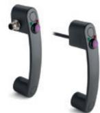
Contact normalement ouvert (NO) de type bistable. La commutation s'effectue en appuyant sur le bouton-poussoir violet, et celle-ci perdure jusqu'à ce que l'on n'appuie pas à nouveau sur le bouton-poussoir. Une LED rouge et une LED verte peuvent être configurées avec un logiciel extérieur. Connecteur mâle ou câble à 8 pôles, sortie postérieure ou latérale. Degré de protection IP 65. Assemblage frontal au moyen de trous passants pour vis à tête cylindrique. Entraxe pour l'assemblage: 132 mm
