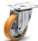
Moyeu avec roulements à billes. C'est une solution idéale pour les charges élevées et pour les déplacements de type continu. Support en tôle d'acier zingué, platine fixe ou pivotante (également avec trou passant central), avec ou sans frein. Excellentes caractéristiques de résistance au roulement et à l'élasticité, haute résistance à l'usure et à la déchirure. Roue Ø: 80 - 100 - 125 - 150 - 200 mm
