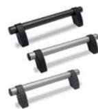
Tube en aluminium avec revêtement en résine époxy, anodisé couleur naturelle. Supports latéraux en technopolymère. Assemblage frontal ou à l'arrière au moyen de trous passants pour vis à tête cylindrique, des vis à six pans creux ou écrous. Entraxes pour l'assemblage: 295 - 345 - 395 - 495 - 595 - 695 mm
