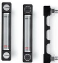
Protection en SUPER-technopolymère. Joints d'étanchéité à gradin pour l'étanchéité sur la paroi du réservoir et joint torique sous tête de la vis en caoutchouc synthétique NBR. HCZ-PT : vis, écrous et rondelles en acier zingué. HCZ-PT-VT : vis en SUPER-technopolymère, écrous et rondelles en acier INOX AISI 304. Température maximum d'exercice en continu : 90 °C. Entraxes pour l'assemblage: 76 - 127 - 254 mm
