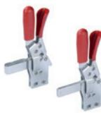
Douilles de support en acier trempé et rectifié. Poignée en polyuréthane, couleur rouge. Bandage levier anti-décrochage en polychlorure de vinyle (PVC). Avec levier de serrage ouvert et deux rondelles pliées ou avec levier de serrage plein et bande pour soudage. Dimensions: 85 - 110,5 mm
