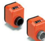
Boîtier et support de base en technopolymère ; voyant transparent en technopolymère. Douille en acier bruni ou en acier INOX AISI 303 avec trou Ø 14 alésé H7, fixation à l'arbre au moyen d'une vis de pression. Couleur orange, gris ou anthracite. Large gamme de lectures disponibles.
