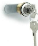
Stator et rotor en alliage de zinc, écrou en laiton, levier, rondelle de positionnement et rondelle élastique en acier zingué. Deux clés en laiton nickelé, extractibles en deux positions à 180°. Exécutions standard: serrure à chiffrement différencié ou unique. Dimensions: de 13 à 30 mm
