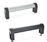
Tube en aluminium anodisé, naturel ou avec un revêtement en résine époxy, couleur noire. Supports latéraux en alliage de zinc. Assemblage à l'arrière au moyen de vis en acier zingué avec trous taraudés ou assemblage frontal au moyen de vis, d'écrous et de rondelles en acier INOX AISI 304. Entraxes pour l'assemblage: 200 - 250 - 300 - 400 - 500 - 600 - 800 mm
