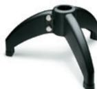
Vis M10, écrous et rondelles en acier zingué ou acier INOX AISI 304. Assemblage sur les pieds réglables séries LS.A, LV.A, LV.F. Les trois appuis de la base sont fournis avec douilles en laiton, trou passant fileté pour l'assemblage de la tige. Trous positionnement tube Ø: 42 - 48 - 50 - 60 - 45x45 mm
