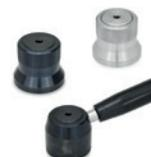
Avec ou sans bras de levier. Douille, trou alésé H7 et rainure pour clavette; ancrage à l'arbre au moyen d'une clavette ou d'une goupille transversale. Le dispositif interne permet de petits mouvements de rotation et le positionnement conséquent des composants de la machine. Diamètres: 44 - 52 mm
