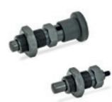
Embout en acier bruni avec extrémité trempée. Corps fileté en acier bruni. Avec ou sans position d'arrêt. Exécutions standard : avec ou sans bouton en technopolymère et contre-écrou. Embout Ø: 4 - 5 - 6 - 8 - 10 - 12 - 16 mm
