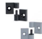
Goujon de rotation en technopolymère autolubrifiant. Assemblage au moyen de trous passants avec siège pour vis à tête fraisée plate M6. Angle de rotation max. 270° (-90° et +180° avec 0° = co-planéité des surfaces). Dimensions: 32 mm
