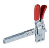
Haltebuchsen aus gehärtetem und geschliffenem Stahl. Roter Griff aus Polyurethan. Sperrhebelabdeckung aus PVC. Die Spezialverlängerung der Sperrklinke ermöglicht die spezielle Verwendung zur Prüfung von Schablonen. Abmessungen: 164 - 198 mm
