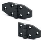
Achsstift Edelstahl 1.4305. Befestigung mit Durchlöchern für Senkschrauben. Das Scharniergehäuse auf der Türpfostenseite ist identisch oder anders als das Scharniergehäuse auf der Türseite. Max. Drehwinkel 270° (-90° und +180° mit 0° = Koplanarität der Oberflächen). Abmessungen: 40 - 50 - 60 mm
