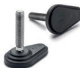
Fuß mit oder ohne rutschfeste NBR-Gummiauflage. Mutter aus Edelstahl 1.4301 auf Anfrage. Befestigung am Boden durch zwei Bohrungen, die durch eine Membran verschlossen sind. Fuß-Ø: 60 - 80 mm. Gewinde: M8 - M10 - M12 - M16
