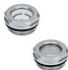
Sichtscheibe aus Naturglas. Dichtungsring aus Gummi NBR. Mit oder ohne Reflektor aus Kunststoff Thermoplast. Maximale Gebrauchstemperatur: 100°C. Metrische Gewinde: M16 - M20 - M26 - M27 - M33 - M42 GAS Gewinde: 3/8 - 1/2 - 3/4 - 1 - 1 1/4
