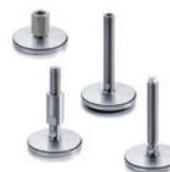
Kugelgelenk mit Gewindebohrung oder Spindel. Fuß mit oder ohne rutschfeste NBR-Gummiauflage. Schraube mit Einstellsechskant, Innensechskant und planen Flächen. Fuß-Ø: 80 - 100 - 120 mm Gewinde: M8 - M10 - M12 - M16 - M20 - M24
