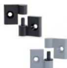
Scharnierflügel und Achsenstift aus Kunststoff Thermoplast, selbstschmierend. Montage über Durchlöcher mit Gehäuse für flache Senkkopfschrauben M6. Max. Drehwinkel 270° (-90° und +180° mit 0° = Koplanarität der Oberflächen). Länge: 32 mm
