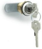
Verriegelung und Gehäuse in Zamac, Mutter aus Messing, Griff, Schließriegel und Federscheibe aus Stahl, verzinkt. Zwei Schlüssel, Messing, vernickelt, die in beiden in 180°-Stellungen abgezogen werden können. Standardausführungen: Schloss mit verschiedenen Kombinationen oder einer Kombination. Abmessungen: von 13 bis 30 mm
