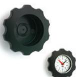
Für Stellungsanzeiger mit Gravitations- oder feststehender Reaktionsbewegung. Buchse aus brüniertem Stahl oder Edelstahl 1.4305, H7 Bohrung, Befestigung auf der Welle mittels Gewindestiften ohne Kopf, Innensechskant, Abdeckkappe. Durchmesser: 85 - 110 mm
