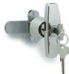
Verriegelung, Gehäuse und Mutter aus Zink-Druckguss; Schließhebel aus verzinktem Stahl; zwei Messingschlüssel, abziehbar in zwei 180°-Stellungen. Schutzart IP 65. Drehwinkel 90° im Uhrzeigersinn. Mit einfacher oder differenzierter Codeverriegelung. Griffgröße: 80 mm
