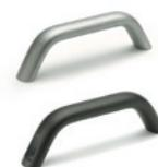
Ovalprofil, Aluminium, naturfarben, mit Kunststoffummantelung, schwarz. Rückseitige Montage über Gewinde-Sacklöcher oder Frontmontage, Durchlöcher für flache Senkkopfschrauben. Achsabstände: 120 - 160 mm
