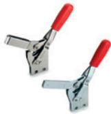
Haltebuchsen aus gehärtetem und geschliffenem Stahl. Roter Griff aus Polyurethan. Mit offenem Spannhebel und zwei Flankenscheiben oder mit massivem Spannhebel und Schweißverbindung. Abmessungen: 66,5 - 85 - 110,5 - 129 - 164 - 223 mm
