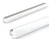
Führungsprofil aus Kunststoff Thermoplast. Bügel aus Edelstahl 1.4301. Breite der Auflagefläche ca. 12 oder 32 mm. Die Führungsschienen werden zur seitlichen Führung von Produkten mit unterschiedlichen Abmessungen an Förderbändern eingesetzt, ohne dabei Spuren an den Behältern zu hinterlassen.
