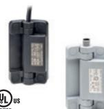
Schalter mit vier elektrischen Schleichschalt-Kontakten mit Doppelunterbrechung und Zb-Form (siehe IEC EN 60947-5-1), die im Werk als Schließer (NO) oder Öffner (NC) eingestellt werden können. Zwangsöffnung nach IEC EN 60947-5-1. Doppelte Isolierung der internen Stromkreise. Länge: 110 mm
