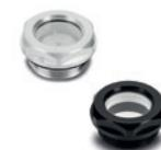
Mit oder ohne Reflektor aus Kunststoff Thermoplast. Sichtscheibe aus ESG-Sicherheitsglas. Dichtungsring aus FKM. Maximale Gebrauchstemperatur: 180°C. Metrische Gewinde (p 1.5): M14 - M16 - M20 - M26 - M27 - M33 - M40 - M42. GAS Gewinde: 1/4 - 3/8 - 1/2 - 3/4 - 1 - 1 1/4 - 1 1/2
