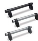
Rohr aus Aluminium mit Kunststoffummantelung, naturfarben eloxiert. Griffschenkel aus Kunststoff-Thermoplast. Front- oder rückseitige Montage über Durchlöcher für Zylinderkopfschrauben, Sechskantschrauben oder Befestigungsmuttern. Achsabstände: 295 - 345 - 395 - 495 - 595 - 695 mm
