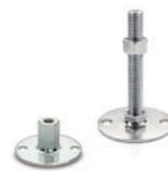
Fuß mit 2 Bohrungen zur Bodenmontage, Gelenk oder Verstellspindel mit Gewinde mit Mutter aus Stahl, verzinkt. Montageschrauben aus Edelstahl 1.4301. Fuß-Ø: 40 - 50 - 60 - 80 mm Gewinde: M8 - M10 - M12 - M16
