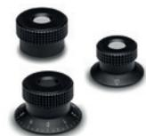
Ohne Markierung, mit Dreieck-Index oder Teilstrichen. Kunststoff Thermoplast Abdeckkappe in Standardfarben. Buchse Messing, Bohrungs-Sackloch. Gesichert durch einen querliegenden Gewindestift.
