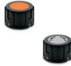
Abdeckkappe aus Thermoplast in den Farben Orange (RAL 2004; C2) oder Grau (RAL 7035; C3), matte Oberfläche, Presspassung. Erhältlich ohne grafisches Symbol, mit Pfeil, der die Skalenrichtung im oder gegen den Uhrzeigersinn anzeigt.
