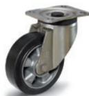
Nabe mit Kugellager. Ideale Lösung für hohe Lasten und laufenden Einsatz. Halter aus verzinktem Stahlblech, festes Lager oder Lenkgehäuse, mit oder ohne Bremse. Rad Ø: 100 - 125 - 160 - 200 mm
