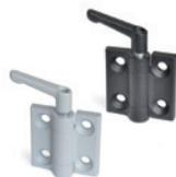
Verstellbarer Klemmhebel zum Spannen aus Zink-Druckguss, kunststoffbeschichtet. Führungsbuchse aus Kunststoff Thermoplast auf Acetalbasis (POM). Mutter mit Gewindefackloch aus verzinktem Stahl, kunststoffbeschichtete Thermoplast (Polyacetal POM) Montage über Durchlöcher mit Gehäuse für flache Senkkopfschrauben. Max. Drehwinkel 270° (-90° und +180° mit 0° = Koplanarität der Oberflächen). Länge: 60 mm
