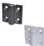
Montage über Durchlöcher mit Gehäuse für flache Senkkopfschrauben. Arretierung bei Winkel  $-90^\circ / 0^\circ / 90^\circ / 180^\circ$ ; Widerstandsmoment 1 Nm. Arretierung bei Winkel  $-3^\circ / 117^\circ$ ; Widerstandsmoment 1 Nm. Max. Drehwinkel  $270^\circ$  ( $-90^\circ$  und  $+180^\circ$  mit  $0^\circ$  = Koplanarität der Oberflächen). Länge: 60 mm
