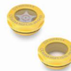
Transparente Sichtscheibe aus Kunststoff Thermoplast. Mit oder ohne Reflektor. Dichtungsring aus Gummi NBR. ATEX-konform gemäß europäischer Richtlinie 94/9/EC. Maximale Gebrauchstemperatur: 80°C. GAS Gewinde: 3/8 - 1/2 - 3/4
