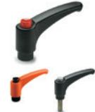
Druckknopf in den Ergostyle-Farben, glänzend. Klemmhebel, Kunststoff Thermoplast, Buchse Messing oder Edelstahl 1.4305, Gewinde-Sackloch; Gewindestift, Stahl, verzinkt oder Edelstahl 1.4305. Radius: 30 - 44 - 63 - 78 - 95 - 108 mm
