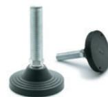
Fuß mit oder ohne rutschfeste NBR-Gummiauflage. Gelenk-Gewindespindel aus poliertem verzinktem Stahl mit Einstellsechskant. Spindel-/Fußbefestigung mit Schraube und Unterlegscheibe aus verzinktem Stahl. Mutter aus verzinktem Stahl auf Anfrage. Fuß-Ø: 125 mm. Gewindespindel: M20 - M24 - M30
