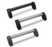
Rohr aus Aluminium mit Kunststoffummantelung, naturfarben eloxiert. Griffschenkel aus Kunststoff-Thermoplast. Front- oder rückseitige Montage über Durchlöcher für Zylinderkopfschrauben, Sechskantschrauben oder Befestigungsmuttern. Achsabstände: 300 - 350 - 400 - 500 - 600 - 700 mm
