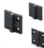
Scharnierflügel und Achsenstift aus Edelstahl 1.4305 Montage mittels Stahlgewindebolzen; Durchlöcher für Senkkopf- oder Zylinderkopfschrauben; Durchgangs-Länglöcher für Zylinderkopfschrauben. Max. Drehwinkel 270° (-90° und +180° mit 0° = Koplanarität der Oberflächen).
