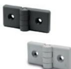
Zentriereinsätze aus Kunststoff Thermoplast für Profile mit einer Nutgröße von 6 bis 12 mm. Montage über Durchlöcher mit Gehäuse für flache Senkkopfschrauben M6. Max. Drehwinkel 280° (-100° und +180° mit 0° = Koplanarität der Oberflächen). Länge: 36 mm
