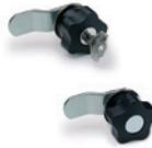
Verriegelung und Gehäuse aus Zink-Druckguss; zwei vernickelte Messingschlüssel, in zwei 180°-Stellungen abziehbar (Schloss offen oder geschlossen). Anschlag rechts oder links; Schloss mit einfacher oder differenzierter Codierung oder ohne Schloss. Sterngriff Durchmesser: 40 mm
