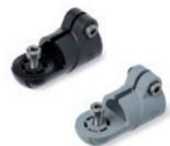
Schwarz oder grau. Zylinderkopfschraube aus Edelstahl (1.4301) mit Innensechskant und Anti-Seize. Selbstsichernde Muttern aus Edelstahl (1.4301). Standardausführungen ohne oder mit Außen- oder Innenverzahnung. Bohrungen Ø: 30 mm
