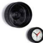
Für Stellungsanzeiger mit Gravitations- oder feststehender Reaktionsbewegung. Buchse aus brüniertem Stahl, H7 Bohrung, Befestigung auf der Welle mittels Gewindestiften ohne Kopf, Innensechskant, Abdeckkappe. Durchmesser: 60 - 80 mm
