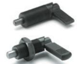
Gewindekörper aus brüniertem Stahl. Gedrehter Stahlbolzen, nitriert. Hebel aus brüniertem Stahl. Mit oder ohne Hebelabdeckung, mit oder ohne Kontermutter. Bolzen Ø: 4 - 5 - 6 - 8 - 10 - 12 mm
