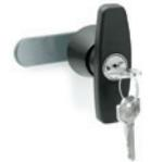
Griff, Verriegelung und Mutter aus Kunststoff Thermoplast, Gehäuse aus Zink-Druckguss; flacher Schließhebel aus verzinktem Stahl; zwei vernickelte Messingschlüssel, abziehbar in zwei 180°-Stellungen. 90° Drehwinkel im Uhrzeigersinn (rechts). Schutzart IP 65. Differenzierte oder einfache Codeverriegelung. Länge: 13,5 mm
