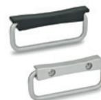
Rückseitige Montage über eine Platte durch Gewinde-Sacklöcher, Frontmontage über Durchlöcher für Zylinderkopfschrauben oder durch Schweißen. 90° oder 180° klappbar. Mit oder ohne Haltefeder.
