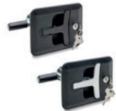
Griff schwarz oder grau. Standardausführungen: Schloss mit verschiedenen Kombinationen oder einer Kombination. Montage mittels 4 verzinkte Schrauben und Muttern mit Gewindegewissung. Das Kippen des Handgriffs in seine Sitzschale bewegt den Schließriegel in Richtung der Schwenktür bis die Verriegelungsposition erreicht ist. Abmessung: 128 mm, Einstellungsweite: von 13 bis 75 mm
