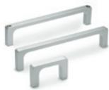
Rechteckprofil, eloxiertes Aluminium, naturfarben oder schwarz. Rückseitige Montage über Gewinde-Sacklöcher oder Frontmontage, Durchlöcher für Zylinderkopfschrauben aus Edelstahl. Geeignet für die Verwendung bei 19" Einschüben und Geräten. Achsabstände: 55 - 88 - 120 - 180 - 235 mm
