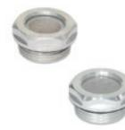
Stahlgewebefilter aus Edelstahl 1.4301 mit Einfassung aus Kunststoff Thermoplast. Dichtungsring aus Gummi NBR. Maximale Gebrauchstemperatur: 100°C. Metrische Gewinde (p 1.5): M20 - M26 - M33 GAS Gewinde: 1/2 - 3/4 - 1
