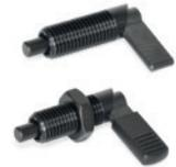
Gewindekörper aus brüniertem Stahl. Gedrehter Stahlbolzen, nitriert. Hebel aus brüniertem Stahl. Links- oder Rechtsdrehung, mit oder ohne Kontermutter. Bolzen Ø: 5 - 6 - 8 - 10 mm
