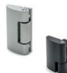
Scharnierflügel und Achsenstift aus Edelstahl 1.4301. Montage durch selbstschneidende Edelstahl-Befestigungsschrauben. Lieferbar mit koplanaem Körper, mit erhöhtem Körper, links oder rechts öffnend. Max. Drehwinkel 185° (-5° und +180° mit 0° = Koplanarität der Oberflächen). Abmessungen: 50 - 70 - 90 mm
