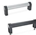
Rohr aus eloxiertem Aluminium, naturfarben oder mit Kunststoffummantelung, schwarz. Seitenstützen aus Zink-Druckguss. Rückseitige Montage über verzinkte Schrauben mit Gewindebohrungen oder Frontmontage über Schrauben, Befestigungsmuttern und Unterlegscheiben aus Edelstahl 1.4301. Achsabstände: 200 - 250 - 300 - 400 - 500 - 600 - 800 mm
