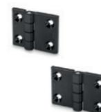
Scharnierflügel und Achsenstift aus Edelstahl 1.4305 Montage über Durchlöcher für flache Senkkopfschrauben Scharnierkörper mit denselben oder unterschiedlichen Abmessungen. Max. Drehwinkel 270° (-90° und +180° mit 0° = Koplanarität der Oberflächen).
