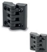
Achsstift Edelstahl 1.4305. Montage mittels vernickelter Messingbuchsen, Gewindebohrung; vernickelte Stahlgewindebolzen; Durchlöcher und Langlöcher (CFA-SL) für Zylinderkopfschrauben Max. Drehwinkel 215° (-35° und +180° mit 0° = Koplanarität der Oberflächen). Abmessungen: 40 - 49 - 65 - 97 mm
