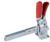
Haltebuchsen aus gehärtetem und geschliffenem Stahl. Roter Griff aus Polyurethan. Sperrhebel mit PVC-Beschichtung. Mit offenem Spannhebel und zwei Flankenscheiben oder mit massivem Spannhebel und Schweißverbindung. Abmessungen: 164 - 198 mm
