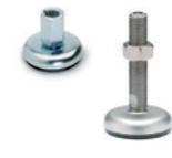
Kugelgelenk mit Gewindebohrung oder Spindel. Rutschfester Gummiauflage (NBR). Innensechskant am oberen Ende der Spindel und gefräste plane Flächen an der Unterseite. Mutter aus Edelstahl 1.4301. Fuß-Ø: 50-60-80-100-120mm Gewinde: M8 - M10 - M12 - M16 - M20 - M24
