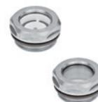
Sichtscheibe aus ESG-Sicherheitsglas. Dichtungsring aus FKM. Mit oder ohne Reflektor aus Kunststoff Thermoplast. Maximale Gebrauchstemperatur: 180°C. Metrische Gewinde: M16 - M20 - M26 - M27 - M33 - M42. GAS Gewinde: 3/8 - 1/2 - 3/4 - 1 - 1 1/4
