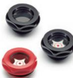
Transparente Sichtscheibe aus Kunststoff Thermoplast. Mit oder ohne Reflektor. Dichtungsring aus Gummi NBR. Maximale Gebrauchstemperatur: 100°C. GAS Gewinde: 3/8 - 1/2 - 3/4 - 1 - 1 1/4 - 2
