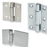
Achsstift Edelstahl 1.4301. Montage durch Schweißen, Bohrungen für Zylinderkopfschrauben oder Bohrungen mit Gehäuse für flache Senkkopfschrauben. Max. Drehwinkel 280° (-100° und +180° mit 0° = Koplanarität der Oberflächen). Abmessungen: 30 - 40 - 45 - 50 - 60 - 75 - 90 mm
