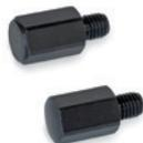
Mit glatter, gedrehter oder geschliffener Kontaktfläche oder mit gedrehter kegelförmiger Kontaktfläche. Dienen der Montage und Positionierung von zu bearbeitenden Teilen. Gewinde: M6 - M8 - M10 - M12 - M16
