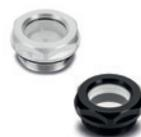
Mit oder ohne Reflektor aus Kunststoff Thermoplast. Sichtscheibe aus Naturglas. Dichtungsring aus Gummi NBR. Maximale Gebrauchstemperatur: 100°C. Metrische Gewinde (p 1.5): M14 - M16 - M20 - M26 - M27 - M33 - M40 - M42. GAS Gewinde: 1/4 - 3/8 - 1/2 - 3/4 - 1 - 1 1/4 - 1 1/2
