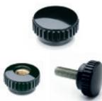
Buchse Messing oder Edelstahl 1.4305, Gewinde Durchloch oder Sackloch; Gewindestift Stahl, verzinkt oder Edelstahl 1.4305. Durchmesser: 15 - 18 - 22 - 25 - 30 - 35 - 40 - 50 mm
