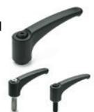
Zinkdruckguß Innenteil für die Verbindung mit dem Klemmelement. Klemmelement, Stahl brüniert oder Edelstahl 1.4305, Gewindebuchse oder Gewindestift. Radius: 44 - 63 - 78 - 95 mm
