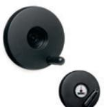
Für Stellungsanzeiger mit Gravitations-Reaktionsbewegung. Buchse, H7 Durchloch, aus brüniertem Stahl oder Edelstahl 1.4305. Mit oder ohne drehbaren oder abklappbaren Griff. Durchmesser: 125 - 160 - 200 mm
