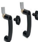
Gehäuse aus Kunststoff Thermoplast, Verschlussring und Verschlusshebel aus Zink-Druckguss. Buchse Messing, Gewinde-Sackloch mit Schlüsselloch für Dreikant oder Doppelbart Steckschlüssel. Drehwinkel 90°. Achsabstand der Befestigung: 117 mm
