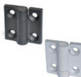
Gehäuse mit Kunststoffbeschichtung. Führungselemente aus Kunststoff Thermoplast auf Acetalbasis (POM). Montage über Durchlöcher mit Gehäuse für flache Senkkopfschrauben. Max. Drehwinkel 270° (-90° und +180° mit 0° = Koplanarität der Oberflächen). Länge: 60 mm
