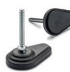
Fuß mit oder ohne rutschfeste NBR-Gummiauflage. Mutter aus Edelstahl 1.4301 auf Anfrage. Befestigung am Boden durch zwei Bohrungen, die durch eine Membran verschlossen sind. Fuß-Ø: 60 - 80 mm.
