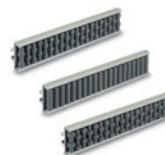
Profil aus eloxiertem Aluminium. Bolzen und Rollenhalterung aus Kunststoff Thermoplast. Bolzen aus Edelstahl AISI 304. Mit zylindrischen oder profilierten Rollen, kugelförmiger oder zylindrischer Kontaktbereich. Dienen zur seitlichen Führung von niedrigen Produkten auf Förderbändern.
