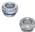
Schutzfilter aus Edelstahl 1.4301. Luftdurchlässige ungewobene Nylonmembran. Dichtungsring, Gummi NBR. Maximale Gebrauchstemperatur: 100°C. Metrische Gewinde: M20 - M28 - M33 GAS Gewinde: 1/2 - 3/4 - 1
