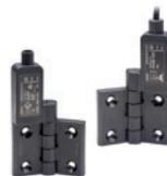
Montage über Durchlöcher mit Gehäuse für flache Senkkopfschrauben M6 UNI 5933, DIN 7991. Anfangs-Arbeitswinkel 0° oder 90°. Sicherheitsschalter mit einem Öffner (NC) und einem Schließer (NO), abwechselnd. Zwangsöffnung nach IEC EN 60947-5-1. Doppelte Isolierung der internen Stromkreise. Länge: 53 mm
