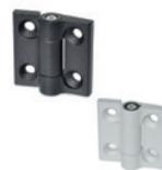
Gehäuse mit Kunststoffbeschichtung. Montage über Durchlöcher mit Gehäuse für flache Senkkopfschrauben. Max. Drehwinkel 270° (-90° und +180° mit 0° = Koplanarität der Oberflächen). Abmessungen: 40 - 50 - 60 mm
