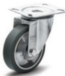
Moyeu avec paliers à billes blindés. Support en tôle d'acier zingué, platine fixe ou pivotante (également avec trou passant central), avec ou sans frein. Sont donc adaptées aux applications dans des zones « ESD PROTECTED AREA » où tous les composants sensibles aux décharges électrostatiques doivent être traités avec le risque minimal d'endommagement. Roue Ø: 80 - 100 - 125 - 150 - 200 mm
