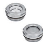
Voyant en verre de sécurité ESG. Rondelle plate en FKM. Avec ou sans réflecteur en technopolymère. Température maximale d'exercice en continu: 180 °C. Filetages métriques: M16 - M20 - M26 - M27 - M33 - M42. Filetages GAZ: 3/8 - 1/2 - 3/4 - 1 - 1 1/4
