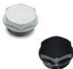
Rondelle plate en FKM. Exécutions standards: aluminium naturel ou anodisé de couleur noir. Température maximale d'exercice en continu: 180 °C. Filetages métriques: M14 - M16 - M20 - M26 - M33 - M42. Filetages GAZ: 1/4 - 3/8 - 1/2 - 3/4 - 1 - 1 1/4 - 1 1/2
