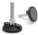
Base avec ou sans disque antiglisse en caoutchouc EPDM. Écrou en acier INOX AISI 304 sur demande. Fixation au sol au moyen de 2 trous à 180° livrés fermés par une membrane. Bases Ø: 80 - 100 mm Filetages: M16 - M20 - M24
