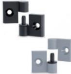
Goujon de rotation en technopolymère autolubrifiant. Assemblage au moyen de trous passants avec siège pour vis à tête fraisée plate M6. Angle de rotation max. 270° (-90° et +180° avec 0° = co-planéité des surfaces). Dimensions: 32 mm
