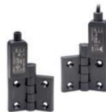
L'interrupteur de sécurité est composé d'un contact normalement ouvert (NO) et d'un contact normalement fermé (NC) d'échange. Ouverture positive selon norme CEI EN 60947-5-1. Double isolation des circuits thermiques. Dimension: 53 mm
