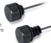
Couvercle en technopolymère; raccord fileté et disque brise-jet extérieur. Rondelle plate en caoutchouc NBR. Jauge de niveau en acier phosphaté. Avec ou sans filtre à air. Température maximale d'exercice en continu: 80 °C. Diamètres: 30 - 40 - 57 mm. Filetages GAZ: 1/4 - 3/8 - 1/2 - 3/4 - 1 - 1 1/4 - 1 1/2. Filetages métriques (pas 1,5): M16 - M18 - M20 - M22 - M24 - M26 - M30
