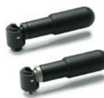
Goujon en acier bruni ou acier INOX AISI 303, support base plat pour assemblage à emboîtement en technopolymère renforcé de fibre de verre. Le dispositif de rappel "Fold-Omatic" remet automatiquement la poignée en position repliée. Dimensions: 65 - 80 - 90 mm
