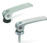
Levier en fonte d'acier zingué. Goujon de rotation et élément de serrage avec trou ou vis fileté en acier zingué. Douille d'appui en acier zingué avec insert de contact en technopolymère ou entièrement en technopolymère. Dimensions: 44 - 63 - 82 - 101 mm
