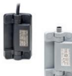
Interrupteur avec quatre contacts électriques configurables en usine : normalement ouvert (NO) ou normalement fermé (NC). Ouverture positive selon norme CEI EN 60947-5-1. Double isolation des circuits internes. Dimension: 110 mm
