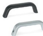
Couleur naturelle ou avec revêtement en résine époxy, couleur grise ou noire. Assemblage à l'arrière au moyen de trous borgnes filetés ou assemblage frontal par des trous passants pour vis à tête cylindrique à six pans creux. Entraxes pour l'assemblage: 120 - 140 mm
