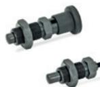
Embout en acier bruni avec extrémité trempée. Corps fileté en acier bruni. Avec ou sans position d'arrêt. Exécutions standard : avec ou sans bouton en technopolymère et contre-écrou. Ø embout : 4 - 5 - 6 - 8 - 10 - 12 - 16 mm
