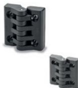
Goujon de rotation en acier INOX AISI 303. Assemblage au moyen de douilles en laiton nickelé, trou fileté; tiges filetées en acier nickelé; alésage et trous oblongs (CFA-SL) passants pour vis à tête cylindrique. Angle de rotation max. 215° (-35° et +180° avec 0° = co-planéité des surfaces). Dimensions: 40 - 49 - 65 - 97 mm
