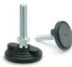
Base avec ou sans disque antiglisse en caoutchouc NBR. Fixation au sol au moyen de 2 trous à 180° livrés fermés par une membrane. Écrou en acier zingué sur demande. Bases Ø: 100 mm Filetages: M8 - M10 - M12 - M16
