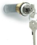
Stator et rotor en alliage de zinc, écrou en laiton, levier, rondelle de positionnement et rondelle élastique en acier zingué. Deux clés en laiton nickelé, extractibles en deux positions à 180°. Exécutions standard: serrure à chiffreage différencié ou unique. Dimensions: de 13 à 30 mm
