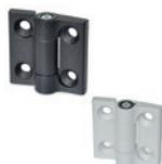
Revêtement du corps en résine époxy. Assemblage au moyen de trous passants avec siège pour vis à tête fraisée plate. Angle de rotation max.  $270^\circ (-90^\circ \text{ et } +180^\circ \text{ avec } 0^\circ = \text{co-planéité des surfaces})$ . Dimensions: 40 - 50 - 60 mm
