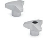
Moyeu non percé, trou borgne alésé H7, trou borgne ou passant fileté. Diamètres: 25 - 32 - 40 - 50 - 60 mm
