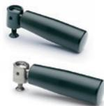
Goujon double guidage en acier bruni ou en acier INOX AISI 303, support de base plat en acier fritté ou en acier INOX fritté AISI 303. Le dispositif de rappel "Fold-Omatic" remet automatiquement la poignée en position repliée. Dimensions: 65 - 80 - 90 mm
