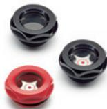
Voyant en technopolymère transparent. Avec ou sans plaquette. Rondelle plate en caoutchouc synthétique NBR. Température maximum d'exercice en continu: 100 °C. Filetages GAZ: 3/8 - 1/2 - 3/4 - 1 - 1 1/4 - 2
