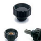
Douille en laiton ou acier INOX AISI 303 avec trou fileté borgne ou passant; tige filetée en acier zingué ou INOX AISI 303.
