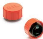
Couvercle en technopolymère de couleur orange; raccord fileté noir. Assemblage à pression sur des tubes. Filtre à air annulaire en mousse de polyuréthane. Température maximum d'exercice en continu: 100°C. Diamètre: 70 mm
