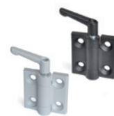
Poignée en alliage de zinc moulé sous pression, couleur noire ou grise. Douille de guidage en technopolymère. Écrou avec trou borgne taraudé en acier, entouré de technopolymère. Assemblage au moyen de trous passants avec siège pour vis à tête fraisée plate. Angle de rotation max.  $270^\circ (-90^\circ \text{ et } +180^\circ \text{ avec } 0^\circ = \text{co-planéité des surfaces})$ . Dimensions: 60 mm
