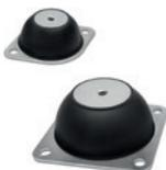
Bride de fixation ovale ou carrée. Douille avec trou borgne fileté. Corps antivibratoire en caoutchouc naturel NR, dureté 40, 60 ±5 Shore A. Diamètres: 18 - 33 - 45 - 53 - 58 mm
