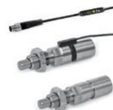
Actionnement pneumatique à simple ou double action. Embout en acier INOX AISI 303 trempé. Corps fileté en acier INOX AISI 303. Avec ou sans position d'arrêt. Ø embout : 6 - 8 - 10 - 12 mm
