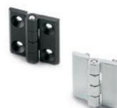
Goujon de rotation en acier INOX AISI 303. Assemblage au moyen de trous passants avec siège pour vis à tête fraisée plate ou tiges filetées en acier INOX AISI 304. Angle de rotation max. 270° (-90° et +180° avec 0° = co-planéité des surfaces). Dimensions: 30 - 40 - 50 - 60 mm
