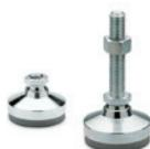
Rotule avec trou ou tige filetée. Disque antivibratoire en élastomère PUR, collé à la base. Ecrou en acier zingué. Bases Ø: 32 - 40 - 50 - 60 mm Filetages: M10 - M12 - M16
