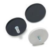
Insert en acier zingué avec goujon fileté. Revêtement antiglisse en élastomère thermoplastique (TPE), couleur noire ou blanche, dureté 80 Shore A. Aimant en néodyme, fer-bore (NdFeB).  $\varnothing D = 12 \div 88$  mm L =  $6 \div 8,5$  mm
