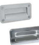
Assemblage frontal au moyen de trous passants pour vis M5 à tête fraisée plate, ou assemblage à l'arrière au moyen de 4 vis M5 soudées au corps de la poignée.
