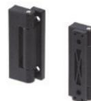
Goujon de rotation en acier INOX AISI 304. Assemblage par trous passants pour vis à tête évasée plate. Angle de rotation max. 180° (-0° et +180° avec 0° = co-planéité des surfaces). Dimension: 75 mm
