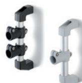
Supports latéraux en technopolymère, couleur noire ou grise. Tube en aluminium anodisé, couleur naturelle. Exécution standard avec une ou deux noix de serrage et de fixation en technopolymère, couleur noire ou grise. Assemblage au moyen de trous passants pour vis à tête cylindrique à six pans creux. Dimensions: 224 - 274 mm
