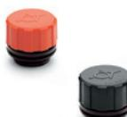
Couvercle en technopolymère de couleur orange ou noir. Raccord fileté de couleur noir. Rondelle plate en caoutchouc synthétique. Valve: avec étalonnage à 10 mb ou 100 mb. Température maximum d'exercice en continu: 100°C. Filetages métriques (pas 1,5): M12 - M14 - M16 - M18 - M20 - M22. Filetages GAZ: 1/4 - 3/8 - 1/2 - 3/4 - 1
