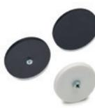
Insert en acier zingué avec trou borgne fileté. Revêtement antiglisse en élastomère thermoplastique (TPE), couleur noire ou blanche, dureté 80 Shore A. Aimant en néodyme, fer-bore (NdFeB).  $\varnothing D = 12 \div 88$  mm L =  $6 \div 8,5$  mm
