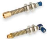
6 exécutions disponibles, avec une course effective de ressort égale à 25,5 mm. La forme hexagonale de la tige empêche au filet et à la ventouse y étant fixée de tourner sur son propre axe. Le ressort permet d'amortir l'impact de la ventouse et de maintenir en même temps une pression constante avec la charge à lever.
