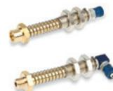
8 exécutions disponibles et avec une course effective du ressort égale à 25,5 mm. Les dimensions réduites permettent une réduction du poids et de l'encombrement sur l'automatisme où elles sont installées. Le ressort permet d'amortir l'impact de la ventouse et de maintenir en même temps une pression constante avec la charge à lever.
