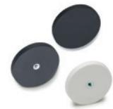
Insert en acier zingué avec trou fileté. Revêtement antiglisse en élastomère thermoplastique (TPE), couleur noire ou blanche, dureté 80 Shore A. Aimant en néodyme, fer-bore (NdFeB).  $\varnothing D = 12 \div 88$  mm L =  $6 \div 8,5$  mm
