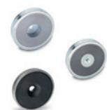
Enveloppe en acier zingué ou acier INOX. Aimant en ferrite, samarium-cobalt (SmCo) ou néodyme-fer-bore (NdFeB), blindé hautes performances. Exécution avec trou passant, siège pour vis à tête fraisée ou trou fileté.  $\varnothing D = 10 \div 100$  mm L =  $4.5 \div 18$  mm
