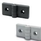
Inserts de positionnement en technopolymère pour profilés, la rainure ayant des dimensions allant de 6 à 12 mm. Assemblage au moyen de trous passants avec siège pour vis à tête fraisée plate M6. Angle de rotation max. 280° (-100° et +180° avec 0° = co-planéité des surfaces). Dimensions: 36 mm
