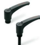
Élément de serrage en technopolymère avec douille en acier bruni ou laiton avec un trou borgne fileté; tige fileté en acier bruni. En cas de chocs accidentels, le levier tourne librement sans compromettre le serrage. Dimensions: 44 - 63 mm
