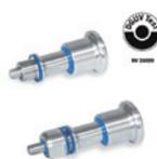
Embout en acier INOX AISI 316. Corps fileté en acier INOX AISI 316. Avec ou sans position d'arrêt. Joint et bague d'étanchéité en caoutchouc synthétique H-NBR conforme aux normes FDA. Destinés à être utilisés dans des environnements nécessitant un haut niveau d'hygiène. Ø embout : 6 - 8 mm
