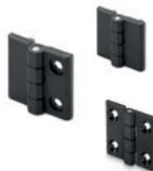
Goujon de rotation en acier INOX AISI 303. Assemblage au moyen de tiges filetées en acier ; trous passants pour vis à tête fraisée ou à tête cylindrique ; trous oblongs avec trou passant pour vis à tête cylindrique. Angle de rotation max. 270° (-90° et +180° avec 0° = co-planéité des surfaces). Dimensions: 30 - 40 - 50 - 60 mm
