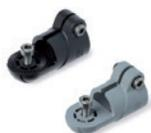
Couleur noire ou grise. Vis à tête cylindrique à six pans creux en acier INOX AISI 304 avec traitement anti-grippage. Écrous autobloquants en acier INOX AISI 304. Exécutions standards sans dents ou avec dents extérieures ou intérieures. Trous Ø: 18 - 30 mm
