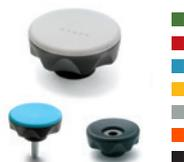
Douille en acier bruni avec trou borgne alésé H9 ou passant alésé H7; douille en laiton avec trou borgne fileté; tige filetée en acier zingué. Calotte dans les couleurs standard fixée au corps du volant par soudage aux ultrasons. Diamètres: 45 - 56 - 70 mm
