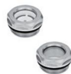
Voyant en verre naturel. Rondelle plate en caoutchouc synthétique NBR. Avec ou sans réflecteur en technopolymère. Température maximum d'exercice en continu: 100°C. Filetages métriques: M16 - M20 - M26 - M27 - M33 - M42. Filetages GAZ: 3/8 - 1/2 - 3/4 - 1 - 1 1/4
