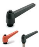
Élément de serrage en technopolymère avec douille en laiton ou acier INOX AISI 303 et trou borgne fileté; tige fileté en acier zingué ou acier INOX AISI 303. Dimensions: 42 - 63 - 80 - 100 mm
