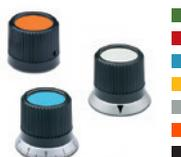
Calotte couvre-douille en technopolymère dans les couleurs standard; bride en aluminium avec index triangulaire ou graduation de précision. Douille en acier bruni, trou alésé H7. Fixation au moyen d'une clavette ou goupille de serrage élastique transversale ou au moyen de vis de pression. Diamètres : 32 - 42 - 48 - 52 - 63 mm
