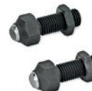
Bille en acier trempé à face plate lisse ou zinguée, non réversible avec un retour automatique en position. Ils servent de supports mobiles ou pour le blocage des pièces à usiner. Filetages: M8 - M10 - M12 - M16 - M20 - M24 - M30x1.5
