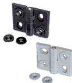
Goujon de rotation en acier INOX AISI 316Ti. Inserts de réglage en alliage de zinc ou acier INOX. Assemblage au moyen de trous passants avec siège pour vis à tête cylindrique ou tête fraisée. Angle de rotation max. 260° (-90° et +170° avec 0° = co-planéité des surfaces). Dimensions: 52 - 64 - 76 mm
