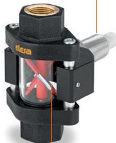
Le capteur inductif (classe de protection IP 67), complètement séparé de la zone de passage du liquide, relève le passage de deux clips métalliques montés sur le rotor, fournissant une variation de fréquence qui peut être transformée en une lecture du débit via la connexion à un PLC.
