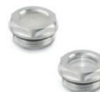
Voyant en technopolymère transparent. Rondelle plate en caoutchouc synthétique NBR. Température maximale d'exercice en continu: 110 °C. Voyant prismatique neutre ou avec petit cercle. Filetages métriques (pas 1.5): M20 - M26 - M27 - M33. Filetages GAZ: 1/2 - 3/4 - 1
