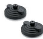
Base avec ou sans disque antiglisse en caoutchouc NBR. Fixation au sol au moyen de 2 trous à 180° livrés fermés par une membrane. Utilisées pour la fixation directe au moyen de vis standard, sans avoir recours à une tige filetée. Filetages: M6 - M8 - M10 - M12 Diamètres: 60 - 70 - 80 - 100 - 125 mm
