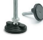
Base avec ou sans disque antiglisse en caoutchouc NBR. Fixation au sol au moyen de 2 trous à 180° livrés fermés par une membrane. Écrou en acier INOX AISI 304 sur demande. Bases Ø: 100 mm Filetages: M8 - M10 - M12 - M16
