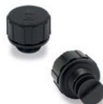
Couvercle en technopolymère; raccord fileté et disque brise-jet extérieur. Rondelle plate en caoutchouc NBR. Avec ou sans filtre à air. Température maximale d'exercice en continu: 80 °C. Diamètres: 30 - 40 - 57 mm. Filetages GAZ: 1/4 - 3/8 - 1/2 - 3/4 - 1 - 1 1/4 - 1 1/2. Filetages métriques (pas 1,5): M16 - M18 - M20 - M22 - M24 - M26 - M30
