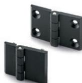
Assemblage au moyen de trous passants avec siège pour vis à tête fraisée plate ou tiges filetées en acier INOX AISI 316. Corps de charnière de dimensions identiques ou de plusieurs dimensions. Angle de rotation max. 270° (-90° et +180° avec 0° = co-planéité des surfaces). Dimensions: 50 - 60 mm
