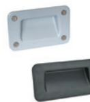
Assemblage frontal au moyen de trous passants pour vis M5 à tête fraisée plate, ou assemblage à l'arrière au moyen de 4 vis M5 soudées au corps de la poignée.
