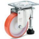
Moyeu avec trou passant. Support en tôle d'acier zingué avec platine pivotante. Pied avec base en technopolymère et tige avec hexagone de régulation en acier zingué. Excellentes caractéristiques de résistance au roulement et d'élasticité, bonne résistance à l'usure et à la déchirure. Roue Ø: 80 - 100 - 125 mm
