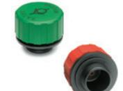
Couleur rouge avec joint d'étanchéité avec membrane en caoutchouc synthétique EPDM, couleur vert avec joint d'étanchéité en caoutchouc synthétique FKM. Température maximum d'exercice en continu: 50°C. Filetage GAZ: 1 1/4
