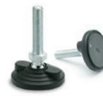
Base avec ou sans disque antiglisse en caoutchouc synthétique NBR. Écrou en acier zingué sur demande. Fixation au sol au moyen de 2 trous à 180° livrés fermés par une membrane. Bases Ø: 80 - 100 - 125 mm Filetages: M8 - M10 - M12 - M14 - M16 - M20 - M24
