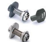
BOCK: tige en acier nickelé; douille de guidage et bague d'arrêt en laiton nickelé; came en acier fritté et trempé; ressort en acier zingué. BOCK-SST: tige, douille de guidage, bague d'arrêt, came et ressort en acier INOX. Ouverture à droite ou à gauche. Longueurs: 46 - 54 - 64 mm
