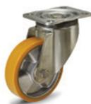
Moyeu avec roulements à billes. C'est une solution idéale pour les charges élevées et pour les déplacements de type continu. Support en tôle d'acier zingué, platine fixe ou pivotante, avec ou sans frein. Excellentes caractéristiques de résistance au roulement et à l'élasticité, haute résistance à l'usure et à la déchirure. Roue Ø: 125 - 150 - 200 mm
