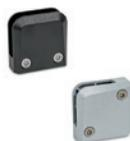
Les pincés GN 939 sont utilisées pour fixer des panneaux en verre, en plastique ou en matériaux divers. Elles sont disponibles sous forme de pincés d'angle ou centrales. Les panneaux sont bloqués entre les inserts en caoutchouc. Il est également possible de choisir le type de blocage dans la version avec goujon de fixation ou plaque d'arrêt.
