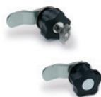
Stator et rotor en alliage de zinc moulé sous pression; deux clés en laiton nickelé, extractibles en deux positions à 180° (serrure ouverte ou fermée). Ouverture à droite ou à gauche; serrure à code différencié, unique, différencié ou sans serrure. Diamètre du petit volant: 40 mm
