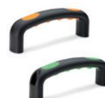
Inserts en élastomère thermoplastique dans les couleurs standard. Assemblage à l'arrière au moyen de douilles en laiton avec trous borgnes filetés ou assemblage frontal par des trous passants pour vis à tête cylindrique à six pans creux. Entraxe pour l'assemblage: 132 mm
