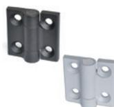
Revêtement du corps en résine époxy. Éléments de guidage en technopolymère à base acétalique (POM). Assemblage au moyen de trous passants avec siège pour vis à tête fraisée plate. Angle de rotation max. 270° (-90° et +180° avec 0° = co-planéité des surfaces). Dimensions: 60 mm
