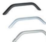
Couleur naturelle ou avec revêtement en résine époxy, couleur grise ou noire. Assemblage à l'arrière au moyen de trous borgnes filetés ou assemblage frontal, trous passants pour vis, écrous et rondelles en acier INOX AISI 304. Entraxes pour l'assemblage: 120 - 140 mm
