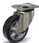
Moyeu avec roulements à billes. C'est une solution idéale pour les charges élevées et pour les déplacements de type continu. Support en tôle d'acier zingué, platine fixe ou pivotante, avec ou sans frein. Roue Ø: 100 - 125 - 160 - 200 mm
