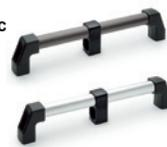
Tube en aluminium avec revêtement en résine époxyde ou anodisé en couleur naturelle. Supports latéraux anti-rotation du tube. Montage à l'arrière au moyen de douilles avec des trous borgnes filetés ou montage à l'avant par des trous passants pour vis à tête cylindrique. Entraxes pour l'assemblage: 700 - 1000 mm
