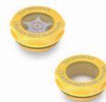
Voyant en technopolymère transparent. Avec ou sans plaquette. Rondelle plate en caoutchouc synthétique NBR. Conformés à la directive européenne ATEX 94/9/EU. Température maximale d'exercice en continu: 80 °C. Filetages GAZ: 3/8 - 1/2 - 3/4.
