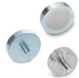
Enveloppe en acier zingué ou acier INOX AISI 316L. Aimant en ferrite, néodyme-fer-bore (NdFeB) ou samarium-cobalt (SmCo), blindé hautes performances.  $\varnothing D = 10 \div 125$  mm L =  $4.5 \div 26$
