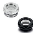
Avec ou sans réflecteur en technopolymère. Voyant en verre naturel. Rondelle plate en caoutchouc synthétique NBR. Température maximum d'exercice en continu: 100°C. Filetages métriques (pas 1.5): M14 - M16 - M20 - M26 - M27 - M33 - M40 - M42. Filetage GAZ: 1/4 - 3/8 - 1/2 - 3/4 - 1 - 1 1/4 - 1 1/2
