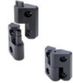
Pour portillons amovibles dotés de système de verrouillage, activable au moyen d'une clé hexagonale ou clavette. Assemblage par trous passants pour vis à tête évasée plate. Angle de rotation max. 195° (-15° et +180° avec 0° = co-planéité des surfaces). Dimension: 60 mm
