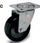
Support en tôle d'acier INOX AISI 304, platine pivotante (également avec trou passant central), sans frein. La résistance aux hautes températures permet de les utiliser dans les industries alimentaires et les fours de cuisson, en particulier dans le secteur de la boulangerie. Roue Ø: 80 - 100 mm
