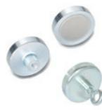
Enveloppe et insert fileté, en forme de crochet ou d'œillet en acier zingué ou acier INOX. Aimant en ferrite, en samarium-cobalt (SmCo) ou néodyme-fer-bore (NdFeB), blindé hautes performances.  $\varnothing D = 10 \div 125$  mm L =  $4.5 \div 26$  mm
