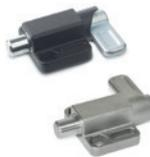
Corps avec trous pour la fixation en acier zingué ou acier INOX AISI 316. Embout en acier zingué ou en acier INOX AISI 316. Avec levier en position de retrait gauche ou droite. Ø embout: 0.31 - 0.39 - 0.47 - 0.55 - 0.63 - 0.79 inch
