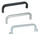
Barre à section ovale plate en aluminium couleur naturelle, avec revêtement en résine époxy, couleur argent ou noire. Assemblage postérieur par trous borgnes filetés. Entraxes pour l'assemblage: 4.72 - 6.30 - 7.09 - 7.87 - 9.84 - 11.81 - 13.78 - 15.75 inch
