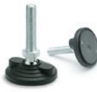
Base avec ou sans disque antiglisse en caoutchouc NBR. Fixation au sol au moyen de 2 trous à 180° livrés fermés par une membrane. Écrou en acier zingué sur demande. Bases Ø: 3.94 inch Filetages: M8 - M10 - M12 - M16
