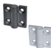
Revêtement du corps en résine époxy. Éléments de guidage en technopolymère à base acétalique (POM). Assemblage au moyen de trous passants avec siège pour vis à tête fraisée plate. Angle de rotation max. 270° (-90° et +180° avec 0° = co-planéité des surfaces). Dimensions: 2.36 inch
