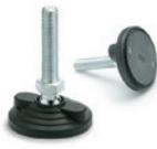
Base avec ou sans disque antiglisse en caoutchouc synthétique NBR. Écrou en acier INOX AISI 304 sur demande. Fixation au sol au moyen de 2 trous à 180° livrés fermés par une membrane. Bases Ø: 3.15 - 3.94 - 4.92 inch Filetages: M8 - M10 - M12 - M14 - M16 - M20 - M24
