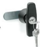
Poignée, stator et écrou en technopolymère; rotor en alliage de zinc; petit levier de fermeture plate en acier zingué; deux clés en laiton nickelé, extractibles en deux positions à 180°. Rotation à 90° dans le sens des aiguilles d'une montre (à droite). Degré de protection IP 65. Serrure à code différencié ou à code unique. Dimensions: 0.53 inch
