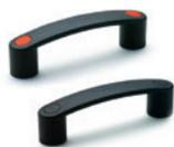
Calottes couvre-douille dans des couleurs standard. Assemblage à l'arrière au moyen de douilles en laiton avec trous borgnes filetés ou assemblage frontal par des trous passants pour vis à tête cylindrique à six pans creux. Entraxes pour l'assemblage: 3.70 - 4.61 - 4.72 - 5.20 - 5.91 - 7.09 inch
