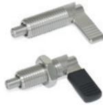
Corps fileté en acier INOX AISI 303. Embout en acier INOX AISI 303. Levier en acier INOX AISI 303. Rotation du levier dans le sens des aiguilles d'une montre ou dans le sens inverse des aiguilles d'une montre, avec ou sans contre-écrou.
