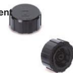
Couvercle en technopolymère de couleur noir; raccord fileté de couleur noir. Rondelle plate en caoutchouc NBR. Filtre à air en mousse de polyuréthane. Température max. d'exercice: 212°F. Filetages GAZ: 3/4
