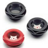
Voyant en technopolymère transparent. Avec ou sans plaquette. Rondelle plate en caoutchouc synthétique NBR. Température maximum d'exercice en continu: 212°F. Filetages GAZ: 3/8 - 1/2 - 3/4 - 1 - 1 1/4 - 2
