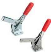
Douilles de support en acier trempé et rectifié. Poignée en polyuréthane, couleur rouge. Avec levier de serrage ouvert et deux rondelles pliées ou avec levier de serrage plein et bande pour soudage. Dimensions: 2.62 - 3.35 - 4.35 - 5.08 - 6.46 - 8.78 inch
