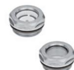
Voyant en verre de sécurité ESG. Rondelle plate en FKM. Avec ou sans réflecteur en technopolymère. Température maximale d'exercice en continu: 356°F. Filetages métriques: M16 - M20 - M26 - M27 - M33 - M42. Filetages GAZ: 3/8 - 1/2 - 3/4 - 1 - 1 1/4
