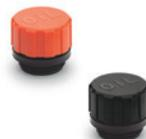
Couvercle en technopolymère de couleur orange ou noir. Raccord fileté en technopolymère noir ou fixation rapide à baïonnette en acier zingué. Avec ou sans filtre à air. Rondelle plate en caoutchouc synthétique NBR. Température maximum d'exercice en continu: 212°F. Diamètres: 1.18 - 1.57 - 2.24 - 2.75 inch. Filetages métriques (pas 1.5): M12 - M14 - M16 - M18 - M20 - M22
