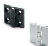
Goujon de rotation en acier INOX AISI 303. Assemblage au moyen de trous passants avec siège pour vis à tête fraisée plate ou tiges filetées en acier INOX AISI 304. Angle de rotation max. 270° (-90° et +180° avec 0° = co-planéité des surfaces). Dimensions: 1.18 - 1.57 - 1.97 - 2.36 inch
