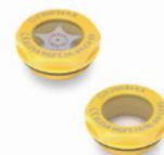
Voyant en technopolymère transparent. Avec ou sans plaquette. Rondelle plate en caoutchouc synthétique NBR. Conformés à la directive européenne ATEX 94/9/EU. Température maximale d'exercice en continu: 176°F. Filetages GAZ: 3/8 - 1/2 - 3/4.
