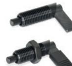
Corps fileté en acier bruni. Embout en acier tourné et nitruré. Levier en acier bruni. Rotation du levier dans le sens des aiguilles d'une montre ou dans le sens inverse des aiguilles d'une montre, avec ou sans contre-écrou. Ø embout: 0.20 - 0.24 - 0.31 - 0.39 inch
