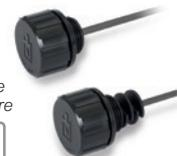
Couvercle en technopolymère; raccord fileté et disque brise-jet extérieur. Rondelle plate en caoutchouc NBR. Jauge de niveau en acier phosphaté. Avec ou sans filtre à air. Température maximale d'exercice en continu: 176°F. Diamètres: 1.18 - 1.57 - 2.24 inch. Filetages GAZ: 1/4 - 3/8 - 1/2 - 3/4 - 1 - 1 1/4 - 1 1/2. Filetages métriques (pas 1.5): M16 - M18 - M20 - M22 - M24 - M26 - M30
