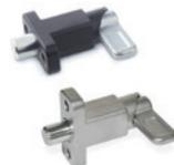
Corps avec trous pour la fixation en acier zingué ou acier INOX AISI 316. Embout en acier zingué ou en acier INOX AISI 316. Avec levier perpendiculaire ou parallèle par rapport à l'axe des trous de fixation. Ø embout: 0.31 - 0.39 - 0.47 - 0.55 - 0.63 - 0.79 inch
