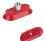
Elles sont utilisées dans le secteur de la robotique automobile, également sur des surfaces fines comme les tôles ou le verre. La flexibilité de la lèvres de préhension leur permet de s'adapter aux surfaces planes, concaves et convexes. Le labyrinthe façonné sur la surface d'appui offre, également en présence de liquides (huile, eau), une grande adhérence à la surface de charge.
