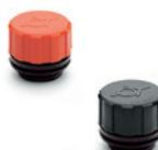
Couvercle en technopolymère de couleur orange ou noir. Raccord fileté de couleur noir. Rondelle plate en caoutchouc synthétique. Valve: avec étalonnage à 10 mb ou 100 mb. Température maximum d'exercice en continu: 212°F. Filetages métriques (pas 1.5): M12 - M14 - M16 - M18 - M20 - M22. Filetages GAZ: 1/4 - 3/8 - 1/2 - 3/4 - 1
