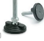
Base avec ou sans disque antiglisse en caoutchouc NBR. Fixation au sol au moyen de 2 trous à 180° livrés fermés par une membrane. Écrou en acier INOX AISI 304 sur demande. Bases Ø: 3.94 inch Filetages: M8 - M10 - M12 - M16
