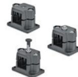
Aluminium, bandage en résine époxy, de couleur noir. Vis et écrous en acier INOX AISI 304. Avec trou fileté; avec presseur à bille et ressort, en acier inox AISI 303; avec piston de positionnement à ressort et blocage en position de retrait, en acier inox AISI 303. Contre-écrou en acier INOX AISI 303 Trous: 0.98 - 1.18 - 1.57 - 1.97 inch
