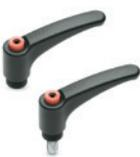
Bouton de reprise pour vissage rapide en phase d'assemblage à l'aide d'une visseuse. Élément de serrage en technopolymère avec douille en laiton et trou borgne fileté; tige fileté en acier zingué. Dimension: 3.07 inch
