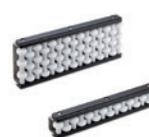
Guides avec une, deux, trois ou quatre rangées de rouleaux. Profilé en acier INOX AISI 304. Support de goujons et rouleaux en technopolymère à base acétalique. Goujons en acier INOX AISI 304. Avec rouleaux façonnés, zone de contact cylindrique. Il s'agit de structures autoportantes particulièrement solides, adaptées au déplacement de produits de poids et dimensions importants.
