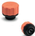
Couvercle en technopolymère orange. Raccord fileté et filtre à air. Valve de surpression réglée à 0,350 bar. Valve d'aspiration réglée à 0,030 bar. Température maximum d'exercice en continu: 212°F. Filetages: M42 - 3/8 - 1/2 - 3/4 - 1 - 1 1/4 - 1 1/2 - 2.
