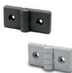
Inserts de positionnement en technopolymère pour profilés, la rainure ayant des dimensions allant de 0.24 à 0.47 inch. Assemblage au moyen de trous passants avec siège pour vis à tête fraisée plate M6. Angle de rotation max. 280° (-100° et +180° avec 0° = co-planéité des surfaces). Dimensions: 1.42 inch
