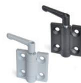
Poignée en alliage de zinc moulé sous pression, couleur noire ou grise. Douille de guidage en technopolymère. Écrou avec trou borgne taraudé en acier, entouré de technopolymère. Assemblage au moyen de trous passants avec siège pour vis à tête fraisée plate. Angle de rotation max.  $270^\circ$  ( $-90^\circ$  et  $+180^\circ$  avec  $0^\circ$  = co-planéité des surfaces). Dimensions: 2.36 inch
