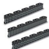
Structure autoportante et rouleaux en technopolymère. Goujons en acier INOX AISI 304. Avec rouleaux cylindriques ou façonnés, zone de contact sphérique ou cylindrique. Ils sont utilisés pour guider latéralement sur les bandes transporteuses les produits ayant une faible dimension verticale.
