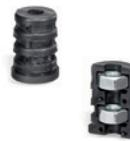
Ecrous DIN 934 en acier zingué brillant. Les deux parties de l'embout sont reliées entre elles par deux goupilles qui sont logées dans des contre-sièges spéciaux. Filetages: M8 - M10 - M12
