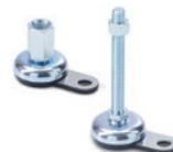
Base avec joint borgne fileté ou avec tige filetée avec à six pans creux et faces plates fraisées au niveau de la base. Support d'ancrage en acier zingué ou INOX AISI 304. Disque antilisse en caoutchouc synthétique NBR.
