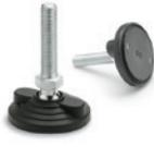
Base avec ou sans disque antiglisse en caoutchouc EPDM. Écrou en acier INOX AISI 304 sur demande. Fixation au sol au moyen de 2 trous à 180° livrés fermés par une membrane. Bases Ø: 3.15 - 3.94 inch Filetages: M16 - M20 - M24
