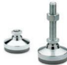
Rotule avec trou ou tige filetée. Disque antivibratoire en élastomère PUR, collé à la base. Ecrou en acier zingué. Bases Ø: 1.26 - 1.57 - 1.97 - 2.36 inch Filetages: M10 - M12 - M16
