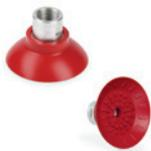
Elles sont utilisées dans le secteur de la robotique automobile et sur des surfaces comme les tôles ou le verre. La flexibilité de la lèvres de préhension leur permet de s'adapter aux surfaces planes, concaves et convexes. Le labyrinthe façonné sur la surface d'appui offre, également en présence de liquides (huile, eau), une grande adhérence à la surface de charge.
