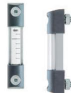
Extrémités de fixation en technopolymère. Protection en aluminium. Protection frontale transparente en polycarbonate. Voyant de niveau à colonne, tube transparent en verre borosilicate. Plaquette en aluminium laqué blanc. Vis, écrous et rondelles en acier INOX AISI 316. Joints d'étanchéité en silicone VQM rouge. Matière première adaptée au contact alimentaire (FDA CFR.21). Entraxes pour l'assemblage: 3 - 5 - 6.93 - 10 - 15 - 20 inch
