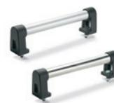
Tube en aluminium anodisé en couleur naturelle, en acier INOX AISI 304 ou en acier INOX AISI 316L. Supports latéraux en technopolymère, couleur noire. Assemblage frontal ou à l'arrière au moyen de trous passants pour vis à six pans creux. Entraxes pour l'assemblage: 7.87 - 9.84 - 11.81 - 15.75 - 19.69 - 23.62 inch
