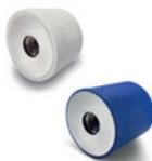
Douille avec trou borgne fileté et plaque de base en acier INOX AISI 304. Corps antivibratoire en caoutchouc de silicone MVQ, couleur grise RAL 7040 ou bleue RAL 5002, dureté 55±5 Shore A. Diamètres: 0.79 - 0.98 - 30 - 1.57 - 1.77 - 1.97 - 2.36 inch
