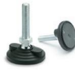
Base avec ou sans disque antiglisse en caoutchouc synthétique NBR. Écrou en acier zingué sur demande. Fixation au sol au moyen de 2 trous à 180° livrés fermés par une membrane. Bases Ø: 3.15 - 3.94 - 4.92 inch Filetages: M8 - M10 - M12 - M14 - M16 - M20 - M24. Filetagess inch: 3/8-16 - 1/2-13 - 5/8-11 - 3/4-10
