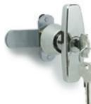
Stator, rotor et écrou en alliage de zinc; petit levier de fermeture en acier zingué; deux clés en laiton, extractibles en deux positions à 180°. Degré de protection IP 65. Rotation 90° droite. Serrure à code différencié ou à code unique. Dimension de la poignée: 3.15 inch.
