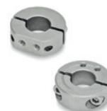
Avec trous taraudés radiaux ou axiaux. Elles sont fixées à l'arbre en serrant la vis de manière appropriée. Elles peuvent être placées sur l'arbre sans devoir les enficher à l'extrémité.
