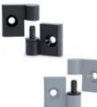
Goujon de rotation en technopolymère autolubrifiant. Assemblage au moyen de trous passants avec siège pour vis à tête fraisée plate M6. Angle de rotation max. 270° (-90° et +180° avec 0° = co-planéité des surfaces). Dimensions: 1.26 inch
