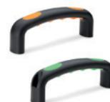
Inserts en élastomère thermoplastique dans les couleurs standard. Assemblage à l'arrière au moyen de douilles en laiton avec trous borgnes filetés ou assemblage frontal par des trous passants pour vis à tête cylindrique à six pans creux. Entraxe pour l'assemblage: 5.20 inch
