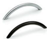
Barre à section ronde en acier chromé, avec un revêtement en résine époxy, couleur grise, noire ou en acier INOX AISI 303. Assemblage postérieur par trous borgnes filetés.
