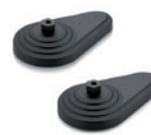
Base avec ou sans disque antiglisse en caoutchouc NBR. Fixation au sol au moyen de 2 trous à 180° livrés fermés par une membrane. Utilisées pour la fixation directe au moyen de vis standard, sans avoir recours à une tige filetée. Filetages: M6 - M8 Diamètres: 2.36 - 3.15 inch
