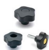
Douille en acier bruni avec trou borgne lisse; douille en laiton, acier INOX ou acier zingué avec trou fileté borgne ou passant; tige fileté en acier zingué ou en acier INOX. Calotte dans les couleurs standard. Diamètres: 0.98 - 1.26 - 1.57 - 1.97 - 2.48 - 2.91 - 3.74 inch
