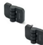
Goujon de rotation en acier INOX AISI 303, entièrement noyé dans le corps de la charnière. Assemblage au moyen de douilles avec trous taraudés ou tiges filetées. Angle de rotation max. 275° (-95° et +180° avec 0° = co-planéité des surfaces). Dimension: 1.97 inch
