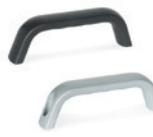
Couleur naturelle ou avec revêtement en résine époxy, couleur grise ou noire. Assemblage à l'arrière au moyen de trous borgnes filetés ou assemblage frontal par des trous passants pour vis à tête cylindrique à six pans creux. Entraxes pour l'assemblage: 4.72 - 5.51 inch
