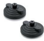
Base avec ou sans disque antiglisse en caoutchouc NBR. Fixation au sol au moyen de 2 trous à 180° livrés fermés par une membrane. Utilisées pour la fixation directe au moyen de vis standard, sans avoir recours à une tige filetée. Filetages: M6 - M8 - M10 - M12 Diamètres: 2.36 - 2.76 - 3.15 - 3.94 - 4.92 inch
