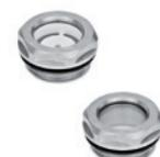
Voyant en verre naturel. Rondelle plate en caoutchouc synthétique NBR. Avec ou sans réflecteur en technopolymère. Température maximum d'exercice en continu: 212°F. Filetages métriques: M16 - M20 - M26 - M27 - M33 - M42. Filetages GAZ: 3/8 - 1/2 - 3/4 - 1 - 1 1/4
