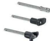
Poignée en L, en T ou avec cavité de préhension. Goujon ou bouton en titane, billes en céramique, poignée en technopolymère ou en titane. En appuyant sur le bouton les deux billes sont relâchées et permettent au goujon de blocage d'être inséré ou extrait. Ø embout: 0.24 - 0.31 - 0.39 inch
