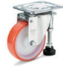
Moyeu avec trou passant. Support en tôle d'acier zingué avec platine pivotante. Pied avec base en technopolymère et tige avec hexagone de régulation en acier zingué. Excellentes caractéristiques de résistance au roulement et d'élasticité, bonne résistance à l'usure et à la déchirure. Roue Ø: 3.15 - 3.94 - 4.92 inch
