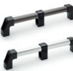
Tube en aluminium avec revêtement en résine époxyde ou anodisé en couleur naturelle. Supports latéraux anti-rotation du tube. Montage à l'arrière au moyen de douilles avec des trous borgnes filetés ou montage à l'avant par des trous passants pour vis à tête cylindrique. Entraxes pour l'assemblage: 27.56 - 39.37 inch
