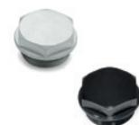
Rondelle plate en caoutchouc synthétique NBR. Exécutions standard: aluminium naturel ou anodisé de couleur noire. Température maximum d'exercice en continu: 212°F. Filetages métriques: M14 - M16 - M20 - M26 - M33 - M42. Filetages GAZ: 1/4 - 3/8 - 1/2 - 3/4 - 1 - 1 1/4 - 1 1/2
