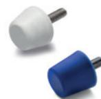
Tige filetée et plaque de base en acier INOX AISI 304. Corps antivibratoire en caoutchouc de silicone MVQ, couleur grise RAL 7040 ou bleue RAL 5002, dureté 55±5 Shore A. Adaptée au contact alimentaire (FDA CFR.21 et EU 10/2011). Diamètres: 0.79 - 0.98 - 30 - 1.57 - 1.77 - 1.97 - 2.36 inch
