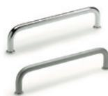
Barre à section ronde en acier chromé, bruni, acier INOX ou en aluminium avec une finition anodisée ou avec un revêtement en résine époxy. Assemblage postérieur par trous borgnes filetés. Entraxes pour l'assemblage: 2.52 - 3.46 - 3.94 - 4.72 - 4.92 - 6.30 - 7.09 - 7.87 - 9.25 - 9.84 - 11.81 inch
