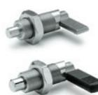
Corps fileté en acier INOX AISI 303. Embout en acier INOX tourné et nitruré. Levier en acier INOX AISI 316. Avec ou sans revêtement du levier, avec ou sans contre-écrou. Embout Ø: 0.20 - 0.24 - 0.31 - 0.39 - 0.47 inch
