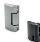
Goujon de rotation en acier INOX AISI 304. Assemblage au moyen de vis de fixation autotaraudeuses en acier INOX. Existe avec corps de co-planéité, avec corps surélevé, ouverture à gauche ou à droite. Angle de rotation max. 185° (-5° e +180° avec 0° = co-planéité des surfaces). Dimensions: 1.97 - 2.76 - 3.54 inch
