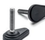
Base avec ou sans disque antiglisse en caoutchouc synthétique NBR. Écrou en acier INOX AISI 304 sur demande. Fixation au sol au moyen de 2 trous livrés fermés par une membrane. Bases Ø: 2.36 - 3.15 inch Filetages: M8 - M10 - M12 - M16
