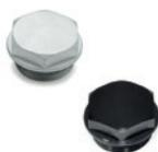
Rondelle plate en FKM. Exécutions standards: aluminium naturel ou anodisé de couleur noir. Température maximale d'exercice en continu: 356°F. Filetages métriques: M14 - M16 - M20 - M26 - M33 - M42. Filetages GAZ: 1/4 - 3/8 - 1/2 - 3/4 - 1 - 1 1/4 - 1 1/2
