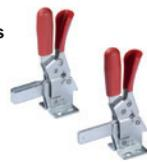
Douilles de support en acier trempé et rectifié. Poignée en polyuréthane, couleur rouge. Bandage levier anti-décrochage en polychlorure de vinyle (PVC). Avec levier de serrage ouvert et deux rondelles pliées ou avec levier de serrage plein et bande pour soudage. Dimensions: 3.35 - 4.35 inch
