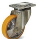
Moyeu avec roulements à billes. C'est une solution idéale pour les charges élevées et pour les déplacements de type continu. Support en tôle d'acier zingué, platine fixe ou pivotante, avec ou sans frein. Excellentes caractéristiques de résistance au roulement et à l'élasticité, haute résistance à l'usure et à la déchirure. Roue Ø: 4.92 - 5.90 - 7.87 inch
