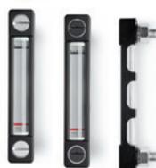
Protection en SUPER-technopolymère. Joints d'étanchéité à gradin pour l'étanchéité sur la paroi du réservoir et joint torique sous tête de la vis en caoutchouc synthétique NBR. HCZ-PT: vis, écrous et rondelles en acier zingué. HCZ-PT-VT: vis en SUPER-technopolymère, écrous et rondelles en acier INOX AISI 304. Température maximum d'exercice en continu: 194°F. Entraxes pour l'assemblage: 3 - 5 - 10 inch
