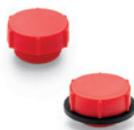
TX: sans joint d'étanchéité. TX-G: avec joint d'étanchéité. Température max. d'exercice: 60° C. Filetages métriques: M8 - M10 - M12 - M14 - M16 - M18 - M20 - M22 - M24 - M25 - M26. Filetages GAZ: 1/8 - 1/4 - 3/8 - 1/2 - 5/8 - 3/4 - 7/8 - 1 - 1 1/4 - 1 1/2 - 2 - 3
