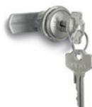
Stator et rotor en acier INOX AISI 316L, petit levier, rondelle et rondelle élastique en acier zingué. Deux clés en laiton nickelé, extractibles en deux positions à 180°. Serrure à code différencié ou à code unique. Dimensions: de 0.51 à 1.18 inch
