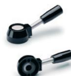
Corps central en technopolymère; bras en acier chromé, poignée cylindrique en Duroplast; plaquette frontale autocollante en aluminium. Trou lisse conformé avec face plate ou douille en acier bruni, trou alésé H7. Dimensions: 4.17 - 4.25 - 5.00 - 6.69 inch
