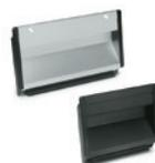
Fermetures latérales en technopolymère. Assemblage à l'arrière au moyen de deux profils en caoutchouc qui assurent une fixation solide et sûre; assemblage frontal au moyen de trous passants pour vis M4 à tête fraisée. Pour tôles d'une épaisseur comprise entre 1.0 et 2.5 mm. Dimensions: 3.94x3.54 - 4.65x3.54 - 6.57x3.54 inch
