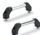
Tube en aluminium anodisé en couleur naturelle, en acier INOX AISI 304 ou en acier INOX AISI 316L. Supports latéraux en technopolymère, couleur noire. Assemblage frontal au moyen de trous passants pour vis à tête cylindrique. Entraxes pour l'assemblage: 7.87 - 9.84 - 11.81 - 15.75 - 19.69 - 23.62 inch
