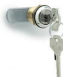
Stator et rotor en alliage de zinc, écrou en laiton, levier, rondelle de positionnement et rondelle élastique en acier zingué. Deux clés en laiton nickelé, extractibles en deux positions à 180°. Exécutions standard: serrure à chiffage différencié ou unique. Dimensions: de 0.51 à 1.18 inch
