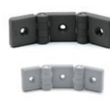
Inserts de positionnement en technopolymère pour profilés, la rainure ayant des dimensions allant de 0.24 à 0.47 inch. Assemblage au moyen de trous passants avec siège pour vis à tête fraisée plate M6. Angle de rotation max. 60°/275° (-95° et +165°/180° étant 0° la condition de co-planéité des surfaces). Dimensions: 1.42 inch
