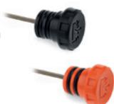
Symbole graphique "remplissage", avec ou sans trou latéral d'échappement. Deux joints toriques en caoutchouc synthétique NBR. Jauge de niveau en acier phosphaté. Température maximum d'exercice en continu: 212°F. Diamètres: 1.02 - 1.18 - 1.38 inch
