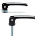
Levier en alliage de zinc moulé sous pression. Goujon de rotation et élément de serrage avec trou ou vis fileté en acier zingué. Douille d'appui en acier zingué avec insert de contact en technopolymère ou entièrement en technopolymère.
