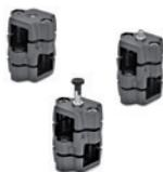
Aluminium, bandage en résine époxy, de couleur noir. Vis et écrous en acier INOX AISI 304. Avec trou fileté; avec presseur à bille et ressort, en acier inox AISI 303; avec piston de positionnement à ressort et blocage en position de retrait, en acier inox AISI 303. Contre-écrou en acier INOX AISI 303. Trous: 0.98 - 1.18 - 1.57 - 1.97 inch
