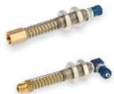
6 exécutions disponibles, avec une course effective de ressort égale à 1.00 inch. La forme hexagonale de la tige empêche au filet et à la ventouse y étant fixée de tourner sur son propre axe. Le ressort permet d'amortir l'impact de la ventouse et de maintenir en même temps une pression constante avec la charge à lever.
