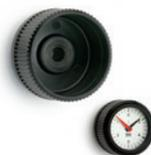
Pour indicateurs avec mouvement à réaction gravitationnelle. Douille en acier bruni, trou alésé H7, fixation à l'arbre au moyen d'une vis de pression sans tête à six pans creux, extrémité en forme de coupe. Diamètres: 2.36 - 3.15 inch
