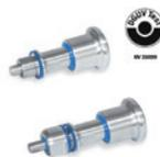
Embout en acier INOX AISI 316. Corps fileté en acier INOX AISI 316. Avec ou sans position d'arrêt. Joint et bague d'étanchéité en caoutchouc synthétique H-NBR conforme aux normes FDA. Destinés à être utilisés dans des environnements nécessitant un haut niveau d'hygiène. Ø embout: 0.24 - 0.31 inch
