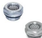
Filtre de protection en acier INOX AISI 304. Membrane transparente en nylon non tissé. Rondelle plate en caoutchouc synthétique NBR. Température maximum d'exercice en continu: 212°F. Filetage métrique: M20 - M28 - M33. Filetage GAZ: 1/2 - 3/4 - 1
