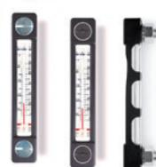
Protection en SUPER-technopolymère. Joints d'étanchéité à gradin pour l'étanchéité sur la paroi du réservoir et joint torique sous tête de la vis en caoutchouc synthétique NBR. HCZ/T-AR-PT: vis, écrous et rondelles en acier zingué. HCZ/T-AR-PT-VT: vis en SUPER-technopolymère, écrous et rondelles en acier INOX AISI 304. Thermomètre incorporé pour la lecture de la température du liquide. Entraxes pour l'assemblage: 3 - 5 - 10 inch
