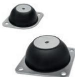
Bride de fixation ovale ou carrée. Douille avec trou borgne fileté. Corps antivibratoire en caoutchouc naturel NR, dureté 40, 60 ±5 Shore A. Diamètres: 0.71 - 1.30 - 1.77 - 2.09 - 2.28 inch
