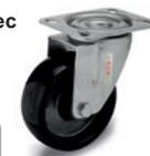
Support en tôle d'acier INOX AISI 304, platine pivotante (également avec trou passant central), sans frein. La résistance aux hautes températures permet de les utiliser dans les industries alimentaires et les fours de cuisson, en particulier dans le secteur de la boulangerie. Roue Ø: 3.15 - 3.94 inch
