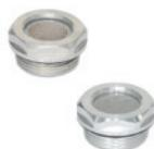
Filtre en maille en acier INOX AISI 304 avec contour en technopolymère. Rondelle plate en caoutchouc synthétique NBR. Température maximum d'exercice en continu: 212°F. Filetages métriques (pas 1.5): M20 - M26 - M33. Filetages GAZ: 1/2 - 3/4 - 1.
