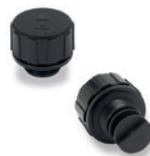
Couvercle en technopolymère; raccord fileté et disque brise-jet extérieur. Rondelle plate en caoutchouc NBR. Avec ou sans filtre à air. Température maximale d'exercice en continu: 176°F. Diamètres: 1.18 - 1.57 - 2.24 inch. Filetages GAZ: 1/4 - 3/8 - 1/2 - 3/4 - 1 - 1 1/4 - 1 1/2. Filetages métriques (pas 1.5): M16 - M18 - M20 - M22 - M24 - M26 - M30
