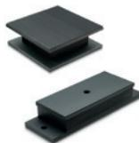
Plaques en acier zingué verni anthracite. Corps antivibratoire en caoutchouc NBR, dureté 30, 50, 55, 60 et 80 Shore A. Dimension: 7.87 inch
