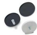
Insert en acier zingué avec goujon fileté. Revêtement antiglisse en élastomère thermoplastique (TPE), couleur noire ou blanche, dureté 80 Shore A. Aimant en néodyme, fer-bore (NdFeB).  $\varnothing D = 0.47 \div 3.46$  inch  $L = 0.24 \div 0.33$  inch
