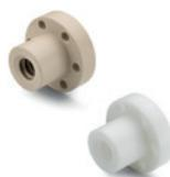
Technopolymère autolubrifiant à base de polyamide ou acétalique, matières premières aptes au contact alimentaire (FDA EU 10/2011). Les écrous à collerette NSF forment, avec les vis NSL, un système permettant de convertir les mouvements rotatifs en translations linéaires. Ils sont généralement utilisés dans le secteur de l'emballage. Diamètres: 1.65 - 1.89 - 2.17 - 2.44 inch
