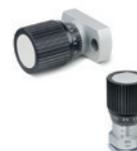
Base en acier chromé; bouton profilé en aluminium moleté. Trous pour vis de fixation parallèles ou perpendiculaires à l'axe de l'arbre. Graduation avec 10 ou 15 traits sur la base chromée et 50 traits sur le bouton. Diamètres: 1.06 - 1.34 inch
