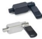
Corps en acier bruni pour soudage ou en acier INOX AISI 304. Embout en acier nitruré ou en INOX AISI 303. Levier en technopolymère, couleur noire. Avec ou sans revêtement du levier.
