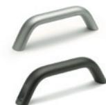
Barre à section ovale en aluminium, couleur naturelle, avec revêtement en résine époxy, couleur noire. Assemblage à l'arrière au moyen de trous borgnes filetés ou assemblage frontal, trous passants pour vis à tête fraisée plate. Entraxes pour l'assemblage: 4.72 - 6.30 inch
