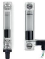
Vis, écrous et rondelles en acier zingué. Joints d'étanchéité à gradin pour l'étanchéité sur la paroi du réservoir et joint torique sous tête de la vis en caoutchouc synthétique NBR. Flotteur en technopolymère avec élément magnétique pour activer le contact. Équerre avec connecteur mâle ou femelle en technopolymère. Capteur avec sortie latérale ou axiale.
