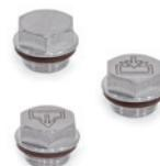
Rondelle plate en FKM. Exécutions standard: neutre, avec symbole de charge ou décharge. Température maximale d'exercice en continu: 356°F. Filetages métriques: M14 - M16 - M20 - M26 - M33. Filetages GAZ: 1/4 - 3/8 - 1/2 - 3/4 - 1
