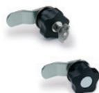
Stator et rotor en alliage de zinc moulé sous pression; deux clés en laiton nickelé, extractibles en deux positions à 180° (serrure ouverte ou fermée). Ouverture à droite ou à gauche; serrure à code différencié, unique, différencié ou sans serrure. Diamètre du petit volant: 1.57 inch
