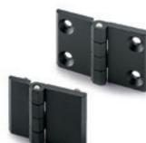
Assemblage au moyen de trous passants avec siège pour vis à tête fraisée plate ou tiges filetées en acier INOX AISI 316. Corps de charnière de dimensions identiques ou de plusieurs dimensions. Angle de rotation max. 270° (-90° et +180° avec 0° = co-planéité des surfaces). Dimensions: 1.97 - 2.36 inch
