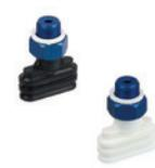
Secteurs d'application: fabrication d'emballage (étuis ou boîtes en carton), le secteur de la céramique (carrelages ou briques) et avec des profils ou des tôles en fer ou acier INOX. Elles se prêtent à la préhension et la fixation de produits aux surfaces allongées. Le soufflet en contact avec la surface de charge (également irrégulière ou sans planéité) se replie en la soulevant du plan.
