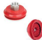
Elles sont utilisées dans le secteur de la robotique automobile, sur des surfaces comme les tôles ou le verre. Le labyrinthe façonné sur la surface d'appui offre, également en présence de liquides (huile, eau), une grande adhérence à la surface de charge. Le soufflet offre également une adaptabilité aux surfaces non régulières ou présentant des défauts de planéité.
