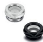
Avec ou sans réflecteur en technopolymère. Voyant en verre naturel. Rondelle plate en caoutchouc synthétique NBR. Température maximum d'exercice en continu: 212°F. Filetages métriques (pas 1.5): M14 - M16 - M20 - M26 - M27 - M33 - M40 - M42. Filetage GAZ: 1/4 - 3/8 - 1/2 - 3/4 - 1 - 1 1/4 - 1 1/2
