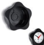
Pour indicateurs avec mouvement à réaction gravitationnelle ou fixe. Douille en acier bruni, trou alésé, fixation à l'arbre au moyen d'une vis de pression sans tête à six pans creux, extrémité en forme de coupe. Diamètres: 2.76 - 3.94 inch
