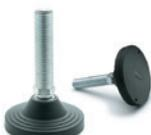
Base avec ou sans disque antiglisse en caoutchouc synthétique NBR. Tige filetée passante en acier zingué brillant avec tête de réglage à six pans. Fixation de la tige/base avec une vis et une rondelle en acier zingué. Écrou en acier zingué sur demande. Bases Ø: 4.92 inch Filetages de la tige : M20 - M24 - M30
