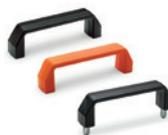
Disponibles en couleur noire ou orange. Assemblage à l'arrière au moyen de douilles en laiton, trous borgnes filetés ou tiges filetées. Entraxes pour l'assemblage: 3.70 - 4.13 - 4.61 - 5.20 - 7.05 inch
