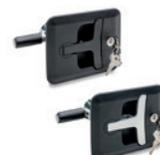
Poignée couleur noire ou grise. Exécutions standard: serrure à chiffage différencié ou unique. Assemblage au moyen de 4 vis en acier zingué co-moulées dans la base. Le basculement de la poignée dans son logement déplace axialement l'arbre avec le levier dans la direction du battant, jusqu'à la position de blocage. Dimension: 5.04 inch, champ de régulation: de 0.51 à 2.95 inch
