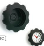
Pour indicateurs avec mouvement à réaction gravitationnelle ou fixe. Douille en acier bruni ou en acier INOX AISI 303, trou alésé, fixation à l'arbre au moyen d'une vis de pression sans tête à six pans creux, extrémité en forme de coupe. Diamètres: 3.35 - 4.33 inch
