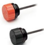
Couvercle en technopolymère de couleur orange ou noir. Raccord fileté noir ou fixation rapide à baïonnette. Avec ou sans filtre à air. Jauge de niveau en acier phosphaté. Température maximum d'exercice en continu: 212°F. Diamètres: 1.18 - 1.57 - 2.24 - 2.75 inch. Filetages métriques (pas 1,5): M16 - M18 - M20 - M22. Filetages GAZ: 1/4 - 3/8 - 1/2 - 3/4 - 1 - 1 1/4 - 1 1/2 - 2
