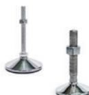
Base en acier INOX AISI 316L. Tige avec hexagone externe ou avec siège pour clé. Joint en caoutchouc NBR, selon FDA. Adaptés pour une utilisation dans des environnements agressifs. Bases Ø: 2.36 - 3.15 - 3.94 - 4.72 inch
