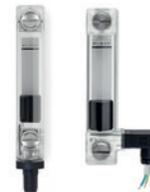
Vis, écrous et rondelles en acier zingué. Joints d'étanchéité à gradin pour l'étanchéité sur la paroi du réservoir et joint torique sous tête de la vis en caoutchouc synthétique NBR. Flotteur en technopolymère avec élément magnétique pour activer le contact.
