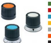
Calotte couvre-douille en technopolymère dans les couleurs standard; bride en aluminium avec index triangulaire ou graduation de précision. Douille en acier bruni, trou alésé H7. Fixation au moyen d'une clavette ou goupille de serrage élastique transversale ou au moyen de vis de pression. Diamètres : 1.26 - 1.65 - 1.89 - 2.05 - 63 inch
