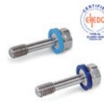
Joint d'étanchéité en caoutchouc synthétique H-NBR ou en EPDM, conforme aux normes FDA. Ce sont des accessoires pour la fixation de pieds réglables destinés à être utilisés dans des environnements exigeant un niveau d'hygiène élevé. Filetages: M5 - M6 - M8 - M10
