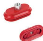
Elles sont utilisées dans le secteur de la robotique automobile, également sur des surfaces fines comme les tôles ou le verre. Le labyrinthe façonné sur la surface d'appui offre, également en présence de liquides (huile, eau), une grande adhérence à la surface de charge. Le soufflet offre également une adaptabilité aux surfaces non régulières ou présentant des défauts de planéité.
