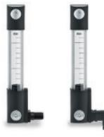
Vis, écrous et rondelles en acier zingué, INOX AISI 304 ou AISI 316. Extrémités de fixation en technopolymère. Protection en aluminium. Tube transparent en polycarbonate ou verre. Protection frontale transparente en polycarbonate. Joints toriques en caoutchouc synthétique NBR ou FKM. Flotteur en technopolymère avec élément magnétique pour activer le contact. Disponibles avec contact électriques NO ou NF. Équerre avec connecteur mâle ou femelle en technopolymère.
