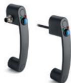
Contact normalement ouvert (NO) et un contact normalement fermé (NC) en inversion ou un contact normalement ouvert (NO) de type bistable. Une DEL rouge et une DEL verte. Connecteur mâle ou câble à 8 pôles, sortie arrière ou latérale. Montage à l'avant au moyen de trous passants pour vis à tête cylindrique. Entraxe pour l'assemblage: 5.20 inch
