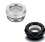
Avec ou sans réflecteur en technopolymère. Voyant en verre de sécurité ESG. Rondelle plate en FKM. Température maximale d'exercice en continu: 356°F. Filetages métriques (pas 1.5): M14 - M16 - M20 - M26 - M27 - M33 - M40 - M42. Filetage GAZ: 1/4 - 3/8 - 1/2 - 3/4 - 1 - 1 1/4 - 1 1/2
