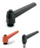
Élément de serrage en technopolymère avec douille en laiton ou acier INOX AISI 303 et trou borgne fileté; tige fileté en acier zingué ou acier INOX AISI 303. Dimensions: 1.65 - 2.48 - 3.15 - 3.94 inch
