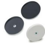
Insert en acier zingué avec trou fileté. Revêtement antiglisse en élastomère thermoplastique (TPE), couleur noire ou blanche, dureté 80 Shore A. Aimant en néodyme, fer-bore (NdFeB).  $\varnothing D = 0.47 \div 3.46$  inch  $L = 0.24 \div 0.33$  inch
