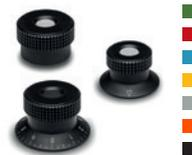
Neutre, index triangulaire ou graduation de précision, gravés au laser. Calotte de fermeture en technopolymère dans les couleurs standard. Douille en laiton, trou borgne lisse. Fixation au moyen d'une vis de pression transversale. Diamètres: 1.18 - 1.57 - 1.97 inch
