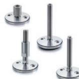
Rotule avec trou ou tige fileté. Base en acier INOX AISI 304 avec trous pour fixation au sol et tige ou rotule borgne filetée en acier INOX AISI 303. Vis avec tête de réglage à six pans, avec six pans creux et faces plates. Base avec ou sans disque antilisse. Bases Ø: 3.15 - 3.94 - 4.72 inch
