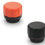
Couvercle en technopolymère de couleur orange ou noir. Raccord fileté en technopolymère noir ou fixation rapide à baïonnette en acier zingué. Avec ou sans filtre à air. Rondelle plate en caoutchouc synthétique NBR. Température maximum d'exercice en continu: 212°F. Diamètres: 1.18 - 1.57 - 2.24 - 2.75 inch. Filetages métriques (pas 1.5): M12 - M14 - M16 - M18 - M20 - M22. Filetages GAZ: 1/4 - 3/8 - 1/2 - 3/4 - 1 - 1 1/4 - 1 1/2 - 2
