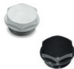
Dichtungsring aus FKM. Standardausführungen: Aluminium naturfarben oder eloxiert in schwarz. Maximale Gebrauchstemperatur: 180°C. Metrische Gewinde: M14 - M16 - M20 - M26 - M33 - M42. GAS Gewinde: 1/4 - 3/8 - 1/2 - 3/4 - 1 - 1 1/4 - 1 1/2
