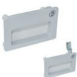
Griff schwarz oder grau. Standardausführungen: Betätigung mit Dreikant, Vierkant 7x7 mit Doppelbart-Steckschlüssel, links oder rechts. Montage mittels 5 Schrauben Stahl, verzinkt. Verriegelungen mit Bügelgriffe GN 115.7 aus Stahl, verzinkt. Abmessung: 128 mm, Einstellungsweite: von 13 bis 75 mm
