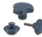
Produziert aus FDA konformen Material (FDA CFR.21 und EU 10/2011). Buchse Edelstahl 1.4301, Gewinde-Sackloch; Gewindestift Edelstahl 1.4301.
