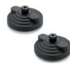
Fuß mit oder ohne rutschfeste NBR-Gummiauflage. Befestigung am Boden durch zwei um 180° versetzte Bohrungen, die durch eine Membran verschlossen sind. Wird für die direkte Befestigung mit Standardschrauben verwendet, ohne dass eine Gewindespindel erforderlich ist. Gewinde: M6 - M8 - M10 - M12 Durchmesser: 60 - 70 - 80 - 100 - 125 mm
