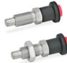
Raststift Stahl gehärtet mit gehärtet oder Edelstahl 1.4305, vernickelt. Gewindekörper aus brüniertem Stahl oder Edelstahl 1.4305. Knopf Thermoplast für den Bolzen. Herausragender oder eingezogener Bolzen, mit oder ohne Kontermutter. Bolzen Ø: 6 - 8 - 10 mm
