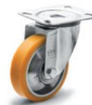
Nabe mit Kugellager. Ideale Lösung für hohe Lasten und laufenden Einsatz. Halter aus verzinktem Stahlblech, festes Lager oder Lenkgehäuse (auch mit mittigem Durchloch) mit oder ohne Bremse. Ausgezeichnete Gleitfähigkeit und Elastizität, hohe Verschleiß- und Reißfestigkeit. Rad Ø: 80 - 100 - 125 - 150 - 200 mm
