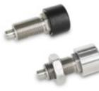
Bolzen und Gewindekörper aus Edelstahl 1.4401. Druckknopf (DRUCK-DRUCK-Verriegelung) aus Kunststoff Thermoplast. Mit oder ohne Kontermutter. Bolzen Ø: 6 - 8 mm
