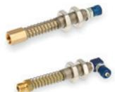
6 verfügbare Ausführungen, mit einem effektiven Federhub von 25,5 mm. Die besondere sechseckige Form des Schafts verhindert, dass er sich mit dem daran befestigten Vakuumsauger um seine Achse dreht. Die Feder dämpft den Aufprall des Vakuumsaugers und hält einen konstanten Druck auf die zu hebende Last aufrecht.
