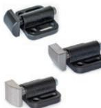
Körper aus Zink-Druckguss. Standardausführungen mit horizontalem oder vertikalem Zylinder, oberer, unterer, rechter oder linker Keil. Druckstift aus Kunststoff oder Edelstahl. Standard- oder verstärkte Druckfeder. Länge: 22 - 32 - 39 mm
