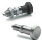
Bolzen aus Edelstahl 1.4305, vernickelt. Gewindekörper aus Edelstahl 1.4305. Knopf aus Kunststoff Thermoplast oder Edelstahl 1.4305. Standardausführungen: mit oder ohne Kontermutter.
