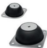
Ovaler oder quadratischer Flansch. Gewindebuchse. Schwingungsdämpfer aus Naturkautschuk (NR), Härte 40, 60 ±5 Shore A. Durchmesser: 18 - 33 - 45 - 53 - 58 mm
