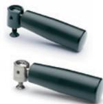
Doppelter Führungsbolzen aus brüniertem Stahl oder Edelstahl 1.4305, flacher Grundträger aus Sinterstahl oder rostfreiem Sinterstahl 1.4305. Dieser Sicherheits-Umleggriff ist mit der ELESA patentierten Rückschwenk-Mechanik „Fold-O-matic“® versehen, so dass dieser nach dem „Loslassen“ wieder umgelegt wird. Länge: 65 - 80 - 90 mm
