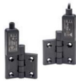
Sicherheitsschalter mit einem Öffner (NC) und einem Schließer (NO), abwechselnd. Positive Öffnung gemäß IEC EN 60947-5-1. Doppelte Isolierung der internen Schaltkreise. Länge: 53 mm
