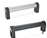
Rohr aus eloxiertem Aluminium, naturfarben oder mit Kunststoffummantelung, schwarz. Seitenstützen aus Zink-Druckguss. Rückseitige Montage über verzinkte Schrauben mit Gewindebohrungen oder Frontmontage über Schrauben, Befestigungsmuttern und Unterlegscheiben aus Edelstahl 1.4301. Achsabstände: 200 - 250 - 300 - 400 - 500 - 600 - 800 mm
