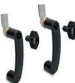
Gehäuse aus Kunststoff Thermoplast, Verschlussring und Verschlusshebel aus Zink-Druckguss. Buchse Messing, Gewindegewissicherung mit Schlüsselloch für Dreikant oder Doppelbart Steckschlüssel. Drehwinkel 90°. Achsabstand der Befestigung: 117 mm
