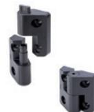
Für abnehmbare Türen, die mit einem Schloss ausgestattet sind, das mit einem Inbusschlüssel oder einer Taste aktiviert werden kann. Befestigung mit Durchlöchern für Senkschrauben. Max. Drehwinkel 195° (-15° und +180° mit 0° = Koplanarität der Oberflächen). Länge: 60 mm
