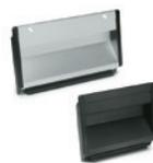
Seitenverschluss aus Thermoplast. Rückseitige Montage über zwei Gummiprofile für eine feste und sichere Befestigung; Frontmontage über Durchlöcher für M4-Senkkopfschrauben. Geeignet für Wandungen mit einer Dicke von 1,0 bis 2,5 mm. Abmessungen: 100x90 - 118x90 - 167x90 mm
