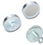
Gehäuse und Gewindeinsatz aus Stahl, verzinkt, oder Edelstahl, haken- oder ösenförmig. Magnet aus Ferrit, Samarium-Kobalt (SmCo) oder Neodym-Eisen-Bor (NdFeB), mit hoher Leistung abgeschirmt.  $\varnothing D = 10 \div 125 \text{ mm}$   $L = 4,5 \div 26 \text{ mm}$
