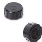
Abdeckkappe aus Kunststoff Thermoplast in schwarz; schwarzes Verbindungsstück mit Gewinde. Dichtungsring aus Gummi NBR. Luftfilter aus Polyurethan-Schaum. Maximale Gebrauchstemperatur 100 °C. GAS Gewinde: 3/4
