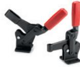
Haltebuchsen und Drehstifte aus gehärtetem und geschliffenem Stahl. Roter Griff aus Polyurethan. Mit offenem Spannhebel und zwei Flankenscheiben oder mit massivem Spannhebel.
