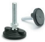
Fuß mit oder ohne rutschfeste NBR-Gummiauflage. Mutter aus Edelstahl 1.4301 auf Anfrage. Befestigung am Boden durch zwei um 180° versetzte Bohrungen, die durch eine Membran verschlossen sind.
