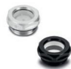
Mit oder ohne Reflektor aus Kunststoff Thermoplast. Sichtscheibe aus Naturglas. Dichtungsring aus Gummi NBR. Polyurethanschaum. Maximale Gebrauchstemperatur 100 °C. Metrische Gewinde (p 1.5): M14 - M16 - M20 - M26 - M27 - M33 - M40 - M42. GAS Gewinde: 1/4 - 3/8 - 1/2 - 3/4 - 1 - 1 1/4 - 1 1/2
