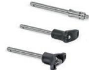
L-Griff, T-Griff oder Griffmulde. Bolzen und Druckknopf aus Titan, Kugeln aus Keramik, Griff aus Kunststoff Thermoplast oder Titan. Durch Drücken des Druckknopfes werden die beiden Sperrklinken eingezogen und der Bolzen kann herausgezogen bzw. eingesteckt werden. Bolzen Ø: 6 - 8 - 10 mm
