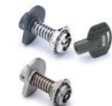
BOCK: Bolzen aus vernickeltem Stahl; Führungsbuchse und Kontermutter aus vernickeltem Messing; Türriegel aus gehärtetem Sinterstahl; Feder aus verzinktem Stahl. BOCK-SST: Bolzen, Führungsbuchse, Kontermutter, Türriegel und Feder aus Edelstahl. Anschlag rechts oder links. Länge: 46 - 54 - 64 mm
