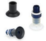
Sie finden in der Verpackungsbranche Verwendung, insbesondere bei der Verpackung mit Kunststofffolien, sowie in der Papierverarbeitung zur Handhabung von Papierbögen. Das geformte Labyrinth auf der Auflagefläche des Vakuumsaugers sorgt für eine effektivere Haftung des zu handhabenden Produkts und eine gleichmäßige Verteilung des Vakuums auf der Oberfläche des Bogens oder der Verpackung.
