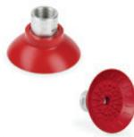
Sie werden im Bereich der Robotik in der Automobilindustrie und für Oberflächen wie Blech oder Glas verwendet. Durch die Flexibilität der Greiflippe eignen sie sich für flache, konkave und konvexe Oberflächen. Das geformte Labyrinth auf der Auflagefläche sorgt selbst bei Vorhandensein von Flüssigkeiten (Öl, Wasser) für einen starken Halt auf der zu greifenden Fläche.
