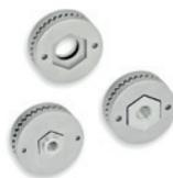
Ohne Durchlochbuchse oder mit Durchlochbuchse mit Gewinde bzw. mit Durchloch mit Gewinde und Zentrierstufe. Druckfeder aus Edelstahl 1.4310 zur Gewährleistung der korrekten Trennung beim Lösen. Mit Hilfe von Rastscheiben können Bauelemente zueinander im definierten Winkel verstellt und formschlüssig arretiert werden. Durchmesser: 35 - 55 - 75 mm
