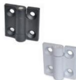
Montage über Durchlöcher mit Gehäuse für flache Senkkopfschrauben. Arretierung bei Winkel  $-90^\circ / 0^\circ / 90^\circ / 180^\circ$ , Widerstandsmoment 1 Nm. Arretierung bei Winkel  $-3^\circ / 117^\circ$ , Widerstandsmoment 1 Nm. Max. Drehwinkel  $270^\circ (-90^\circ \text{ und } +180^\circ \text{ mit } 0^\circ = \text{Koplanarität der Oberflächen})$ . Länge: 60 mm
