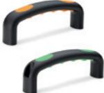
Einsätze aus Thermoplast Elastomer in Standardfarben. Rückseitige Montage über Messingbuchsen mit Gewinde-Sacklöchern oder Frontmontage über Durchlöcher für Zylinderkopfschrauben mit Innensechskant.
