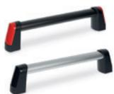
Rohr aus Aluminium mit Kunststoffummantelung oder Aluminium naturfarben. Seitenstützen aus Kunststoff Thermoplast, Schraubenabdeckungen in Standardfarben. Frontmontage über Durchlöcher für Zylinderkopfschrauben, Schrauben mit Innensechskant oder Befestigungsmuttern. Achsabstände: 300 - 350 - 400 - 500 - 600 - 700 mm
