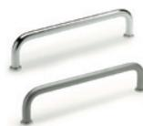
Rundprofil aus verchromtem, brüniertem Stahl, Edelstahl oder Aluminium mit eloxierter Oberfläche oder Kunststoffummantelung. Montage rückseitig mit Gewindefacklöchern. Achsabstände: 64 - 88 - 100 - 120 - 125 - 160 - 180 - 200 - 235 - 250 - 300 mm
