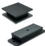
Verzinkte Stahlplatten, anthrazitfarben lackiert. Schwingungsdämpfer aus NBR-Gummi, Härte 30, 50, 55, 60 und 80 Shore A. Länge: 200 mm
