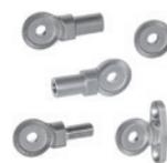
Mit Gewindebolzen oder unbearbeitetem Zapfen (zum Anschweißen), mit Bolzen mit Gewindebohrung; mit horizontalem Befestigungsflansch; Zahnplatte (zum Anschweißen). Mit Hilfe von Rastscheiben können Bauelemente zueinander im definierten Winkel verstellt und formschlüssig arretiert werden. Durchmesser: 22 - 27 - 32 - 40 mm
