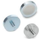
Stahlgehäuse, verzinkt oder aus Edelstahl 1.4404. Leistungsstarker geschirmter Magnet aus Ferrit, Neodym-Eisen-Bor (NdFeB) oder Samarium-Kobalt (SmCo).  $\varnothing D = 10 \div 125 \text{ mm}$   $L = 4,5 \div 26$
