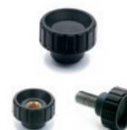
Buchse Messing oder Edelstahl 1.4305, Gewinde Durchloch oder Sackloch; Gewindestift Stahl, verzinkt oder Edelstahl 1.4305. Durchmesser: 12 - 16 - 20 - 25 - 32 - 40 - 50 mm
