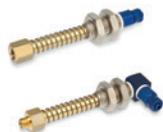
4 verfügbare Ausführungen, jede mit drei verschiedenen effektiven Federhüben, die für jede Schaftlänge individuell ausgelegt sind. Die Feder dämpft den Aufprall des Vakuumsaugers und hält gleichzeitig einen konstanten Druck auf die zu hebende Last aufrecht.
