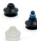
Sie sind besonders für das Wenden und Aufnehmen von Papier- und Kartonbögen, dünnen Blechen und Holzplatten konzipiert. Der Balg ist verstärkt, das heißt, er ist breiter und dicker als herkömmliche Bälge, und ermöglicht bei gleicher Größe eine höhere Hubkraft sowie bietet eine höhere Verschleißfestigkeit.
