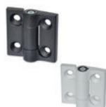
Gehäuse mit Kunststoffbeschichtung. Montage über Durchlöcher mit Gehäuse für flache Senkkopfschrauben. Max. Drehwinkel  $270^\circ (-90^\circ \text{ und } +180^\circ \text{ mit } 0^\circ = \text{Koplanarität der Oberflächen})$ . Abmessungen: 40 - 50 - 60 mm
