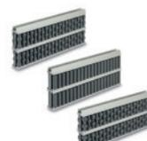
Profil aus eloxiertem Aluminium. Bolzen und Rollenhalterung aus Kunststoff Thermoplast. Bolzen aus Edelstahl AISI 304. Mit zylindrischen oder profilierten Rollen, kugelförmiger oder zylindrischer Kontaktbereich. Dienen zur beidseitigen Führung von höheren Produkten auf Förderbändern.
