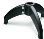
M10, Schrauben Muttern und Scheiben aus Stahl, verzinkt oder Edelstahl 1.4301. Montage an Gelenkfüßen LS.A, LV.A und LV.F. Die drei Abstützungen werden mit Buchse Messing und Gewinde-Durchloch zur Montage der Spindel geliefert. Rohrbohrungs-Ø: 42 - 48 - 50 - 60 - 45x45 mm
