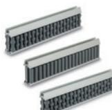
Profil aus eloxiertem Aluminium. Bolzen und Rollenhalterung aus Kunststoff Thermoplast. Bolzen aus Edelstahl AISI 304. Mit zylindrischen oder profilierten Rollen, kugelförmiger oder zylindrischer Kontaktbereich. Dienen zur beidseitigen Führung von niedrigen Produkten auf Förderbändern.
