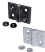
Achsstift Edelstahl 1.4401. Verstellbare Innenteile aus Zink-Druckguss oder Edelstahl. Montage über Durchlöcher mit Gehäuse für Zylinder- oder Senkkopfschrauben. Max. Drehwinkel 260° (-90° und +170° mit 0° = Koplanarität der Oberflächen). Abmessungen: 52 - 64 - 76 mm
