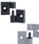
Scharnierflügel und Achsenstift aus Kunststoff Thermoplast, selbstschmierend. Montage über Durchlöcher mit Gehäuse für flache Senkkopfschrauben M6. Max. Drehwinkel 270° (-90° und +180° mit 0° = Koplanarität der Oberflächen). Länge: 32 mm
