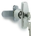
Verriegelung, Gehäuse und Mutter aus Zink-Druckguss; Schließhebel aus verzinktem Stahl; zwei Messingschlüssel, abziehbar in zwei 180° Stellungen. Schutzart IP 65. Drehwinkel 90° im Uhrzeigersinn. Mit einfacher oder differenzierter Codeverriegelung. Griffgröße: 80 mm
