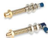
8 verfügbare Ausführungen, mit einem effektiven Federhub von 25,5 mm. Kleine Abmessungen, die eine Verringerung des Gewichts und des Platzbedarfs des Automaten ermöglichen, auf dem sie montiert sind. Die Feder dämpft den Aufprall des Vakuumsaugers und hält einen konstanten Druck auf die zu hebende Last aufrecht.
