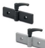
Verstellbarer Klemmhebel zum Spannen, Kunststoff Thermoplast. Zentriereinsätze aus Kunststoff Thermoplast für Profile mit einer Nutgröße von 6 bis 12 mm. Montage über Durchlöcher mit Gehäuse für flache Senkkopfschrauben M6. Max. Drehwinkel  $280^\circ (-100^\circ \text{ und } +180^\circ \text{ mit } 0^\circ = \text{Koplanarität der Oberflächen})$ . Länge: 36 mm
