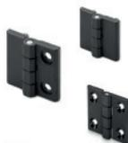
Scharnierflügel und Achsenstift aus Edelstahl 1.4305. Montage mittels Stahlgewindebolzen; Durchlöcher für Senkkopf- oder Zylinderkopfschrauben; Durchgangs-Länglöcher für Zylinderkopfschrauben. Max. Drehwinkel 270° (-90° und +180° mit 0° = Koplanarität der Oberflächen). Abmessungen: 30 - 40 - 50 - 60 mm
