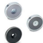
Stahlgehäuse, verzinkt oder aus Edelstahl. Leistungsstarker geschirmter Magnet aus Ferrit, Samarium-Kobalt (SmCo), oder Neodym-Eisen-Bor (NdFeB). Ausführung mit Durchloch, Sitz für Senkkopfschraube oder Gewindebohrung.  $\varnothing D = 10 \div 100 \text{ mm}$   $L = 4,5 \div 18 \text{ mm}$
