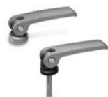
Griff Edelstahl 1.4308. Achse und Klemme mit Gewindebohrung oder Schraube aus Edelstahl 1.4305. Buchse, Stahl verzinkt mit Innenteil aus Kunststoff Thermoplast oder vollständig aus Kunststoff Thermoplast. Länge: 44 - 63 - 82 - 101 mm
