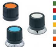
Abdeckkappe aus Kunststoff Thermoplast in Standardfarben; Aluminiumflansch mit dreieckiger Index- oder Präzisionsskala. Buchse Stahl brüniert, H7 Bohrung. Montage mittels Keilnut oder querliegenden elastischen Stiften oder Gewindestiften.
