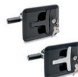
Griff schwarz oder grau. Standardausführungen: Schloss mit verschiedenen Kombinationen oder einer Kombination. Montage mittels 4 verzinkte Schrauben und Muttern mit Gewindegewissicherung. Das Kippen des Handgriffs in seine Sitzschale bewegt den Schließriegel in Richtung der Schwenktür bis die Verriegelungsposition erreicht ist. Abmessung: 128 mm, Einstellungsweite: von 13 bis 75 mm
