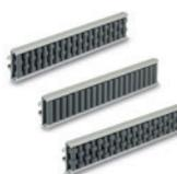
Profil aus eloxiertem Aluminium. Bolzen und Rollenhalterung aus Kunststoff Thermoplast. Bolzen aus Edelstahl AISI 304. Mit zylindrischen oder profilierten Rollen, kugelförmiger oder zylindrischer Kontaktbereich. Dienen zur seitlichen Führung von niedrigen Produkten auf Förderbändern.
