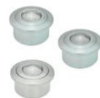
Gedrehter und verzinkter Stahl, Edelstahl 1.4028 oder 1.4305. Kugeln aus Naturstahl oder Edelstahl 1.4034. Sie sind besonders für den Einsatz in Förderanlagen geeignet und ermöglichen sowohl lineare als auch rotatorische Bewegungen, selbst von schweren Lasten. Durchmesser: 22 - 24 - 36 - 45 - 62 - 100 mm
