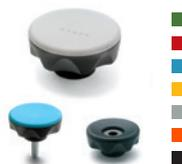
Buchse, Stahl brüniert, Sackloch H9 oder H7 Bohrung Durchloch; Buchse Messing, Gewinde-Sackloch; Gewindestift Stahl, verzinkt. Abdeckkappe in Standardfarben, durch Ultraschallschweißen am Knopf befestigt. Durchmesser: 45 - 56 - 70 mm
