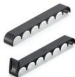
RLT-B Bremsen verlangsamen oder stoppen Transportgüter auf den Rollenbahnen. Die Bremsen werden auf den RLT-U Rollenelementen eingeklippt, Schrauben oder andere Befestigungen sind nicht notwendig.
