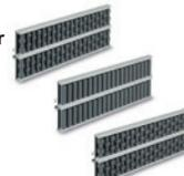
Profil aus eloxiertem Aluminium. Bolzen und Rollenhalterung aus Kunststoff Thermoplast. Bolzen aus Edelstahl AISI 304. Mit zylindrischen oder profilierten Rollen, kugelförmiger oder zylindrischer Kontaktbereich. Dienen zur seitlichen Führung von höheren Produkten auf Förderbändern.
