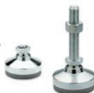
Kugelgelenk mit Gewindebohrung oder Spindel. Dämpfungselement Elastomere (PUR), unter dem Fuß eingeklebt. Verzinkte Stahlmutter. Füße Ø: 32 - 40 - 50 - 60 mm Gewinde: M10 - M12 - M16
