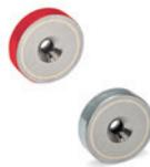
Stahlgehäuse, verzinkt oder lackiert. Magnet aus Aluminium-Nickel-Kobalt (AlNiCo), mit hoher Leistung abgeschirmt.  $\varnothing D = 19 \div 38 \text{ mm}$   $L = 7,5 \div 10,5 \text{ mm}$
