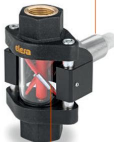
Der induktive Sensor (Schutzart IP 67), der vollständig vom Flüssigkeitsdurchflussbereich abgetrennt ist, liest den Durchfluss an den beiden am Rotor befestigten Metallclips ab, die eine Frequenzänderung liefern, die durch Anschluss an eine SPS in einen ablesbaren Durchflusswert umgewandelt wird.
