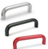
Ovalprofil, naturfarbener Aluminium, eloxiert oder UV-beständige Kunststoffummantelung. Frontmontage über Durchlöcher für Zylinderkopfschrauben. Achsabstände: 100 - 112 - 117 - 120 - 128 - 132 - 160 - 180 - 200 mm
