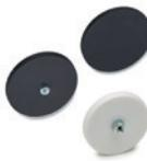
Verzinkter Stahleinsatz mit Gewinde-Sackloch. Gummierete Haftfläche aus Thermoplast Elastomer (TPE), schwarz oder weiß, Härte 80 Shore A. Magnet aus Neodym-Eisen-Bor (NdFeB)  $\varnothing D = 12 \div 88 \text{ mm}$   $L = 6 \div 8,5 \text{ mm}$
