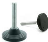
Fuß mit oder ohne rutschfeste NBR-Gummiauflage. Durchgehende Gewindespindel aus verzinktem Stahl mit Einstellsechskant, Ringöse aus brüniertem Stahl und Unterlegscheibe aus verzinktem Stahl. Polierte verzinkte Stahlmutter auf Anfrage. Fuß-Ø: 125 mm. Gewindespindel: M20 - M24 - M30.
