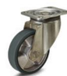
Nabe mit abgeschirmten Kugellagern. Halter aus verzinktem Stahlblech, festes Lager oder Lenkgehäuse, mit oder ohne Bremse. Geeignet für Anwendungen in „ESD-geschützten Bereichen“ (EPA), wo Komponenten, die gegenüber elektrostatischen Entladungen empfindlich sind, mit minimalem Schadensrisiko behandelt werden müssen. Rad Ø: 125 - 150 - 200 mm
