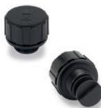
Abdeckkappe aus Kunststoff Thermoplast. Verbindungsstück mit Gewinde und externem Öldichtring. Dichtungsring aus Gummi NBR. Mit oder ohne Luftfilter. Maximale Gebrauchstemperatur: 80°C. Durchmesser: 30 - 40 - 57 mm. GAS Gewinde: 1/4 - 3/8 - 1/2 - 3/4 - 1 - 1 1/4 - 1 1/2 Metrische Gewinde (p 1.5): M16 - M18 - M20 - M22 - M24 - M26 - M30
