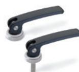
Griff Zink-Druckguss. Achse und Klemme mit Gewindebohrung oder Schraube aus Edelstahl 1.4305. Stützbuchse aus Edelstahl 1.4305 mit Kontakteinsatz aus Kunststoff Thermoplast, oder komplett aus Kunststoff Thermoplast. Länge: 44 - 63 - 82 - 101 mm
