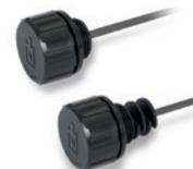
Verbindungsstück mit Gewinde und externem Öldichtring. Dichtungsring aus Gummi NBR. Ölmesstab aus phosphatiertem Stahl. Mit oder ohne Luftfilter. Maximale Gebrauchstemperatur: 80°C. Durchmesser: 30 - 40 - 57 mm. GAS Gewinde: 1/4 - 3/8 - 1/2 - 3/4 - 1 - 1 1/4 - 1 1/2 Metrische Gewinde (p 1.5): M16 - M18 - M20 - M22 - M24 - M26 - M30
