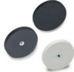
Verzinkter Stahleinsatz mit Gewindebohrung. Gummierete Haftfläche aus Thermoplast Elastomer (TPE), schwarz oder weiß, Härte 80 Shore A. Magnet aus Neodym-Eisen-Bor (NdFeB)  $\varnothing D = 12 \div 88 \text{ mm}$   $L = 6 \div 8,5 \text{ mm}$
