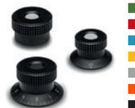
Ohne Markierung, mit Dreieck-Index oder Teilstrichen. Kunststoff Thermoplast Abdeckkappe in Standardfarben. Buchse Messing, Bohrungs-Sackloch. Gesichert durch einen querliegenden Gewindestift. Durchmesser: 30 - 40 - 50 mm
