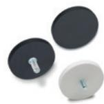
Verzinkter Stahleinsatz mit Gewindezapfen. Gummierete Haftfläche aus Thermoplast Elastomer (TPE), schwarz oder weiß, Härte 80 Shore A. Magnet aus Neodym-Eisen-Bor (NdFeB)  $\varnothing D = 12 \div 88 \text{ mm}$   $L = 6 \div 8,5 \text{ mm}$
