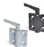
Griff aus Zink-Druckguss, schwarz oder grau. Führungsbuchse aus Kunststoff Thermoplast. Mutter mit Gewinde-Sackloch aus Stahl, umgeben von Kunststoff Thermoplast. Montage über Durchlöcher mit Gehäuse für flache Senkkopfschrauben. Max. Drehwinkel  $270^\circ (-90^\circ \text{ und } +180^\circ \text{ mit } 0^\circ = \text{Koplanarität der Oberflächen})$ . Länge: 60 mm
