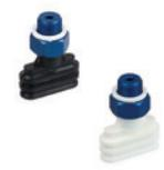
Anwendungsbereiche: Papier (Kartons oder Kisten), Keramik (Fliesen oder Ziegel), Profile aus Eisen oder Edelstahl. Geeignet zum Greifen und Halten von Produkten mit länglichen Oberflächen. Der Balg, der mit der Lastfläche (auch unregelmäßig oder nicht plan) in Kontakt steht, faltet sich zusammen und hebt sie von der Oberfläche ab.
