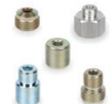
5 verfügbare Ausführungen, die zur Verbindung der Vakuumsauger mit den Vakuumsaugerhaltern verwendet werden und mit Gewinden mit unterschiedlichen Abmessungen ausgestattet sind. Sie ermöglichen sowohl den Übergang von Außen- auf Innengewinde als auch die Anpassung an GAS-, metrische oder NPT-Gewinde.
