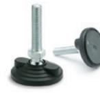
Fuß mit oder ohne rutschfeste NBR-Gummiauflage. Verzinkte Stahlmutter auf Anfrage. Befestigung am Boden durch zwei um 180° versetzte Bohrungen, die durch eine Membran verschlossen sind.
