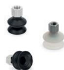
Sie eignen sich zum Wenden und Aufnehmen von dünnen Metallblechen, Glasplatten, Holzplatten und Kunststofflaminaten. Der Vakuumsauger ist vulkanisiert, wodurch er abriebfester, zugfester und verschleißfester wird und aggressiven Umwelteinflüssen besser standhält.
