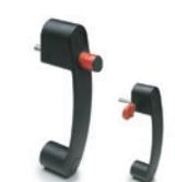
Schlüsselhaltevorrichtung. Verriegelungsbolzen Edelstahl 1.4301 mit Verriegelungsknopf aus Kunststoff Thermoplast. Durchlöcher für Zylinderschrauben mit Innensechskant. Achsabstand: 132 mm
