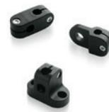
Verriegelung durch M6 Zylinderschrauben. Durch die Form der Aufnahmebohrungen können sowohl runde als auch quadratische Rohre geklemmt werden; die Verwendung von quadratischen Rohren verhindert das Verdrehen. Für die Positionierung von Lichtschranken oder anderen Geräten an den Verpackungslinien.
