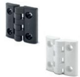
Scharnierflügel und Achsenstift aus Thermoplast. Montage über Durchlöcher für Senkschrauben, Zylinderkopfschrauben, Sechskantschrauben oder Befestigungsmuttern. Drehwinkel: max 200° (-20° und +180° gleich 0° ist der Zustand, bei dem die beiden Scharnierhälften auf derselben Ebene liegen). Abmessungen: 40 - 49 - 65 mm
