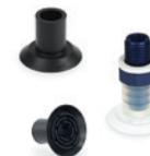
Sie finden in der Verpackungsbranche Verwendung, insbesondere bei der Verpackung mit Kunststofffolien, sowie in der Papierverarbeitung zur Handhabung von Papierbögen. Das geformte Labyrinth auf der Auflagefläche des Vakuumsaugers sorgt für eine effektivere Haftung des zu handhabenden Produkts und eine gleichmäßige Verteilung des Vakuums auf der Oberfläche des Bogens oder der Verpackung.
