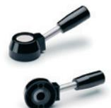
Radkörper aus Kunststoff Thermoplast; Arm aus verchromtem Stahl, zylindrischer Griff aus Duroplast; selbstklebende Frontkontrastscheibe aus Aluminium. Brünierte Stahl-Nabe, Bohrung H7 oder ohne Nabe, einseitig abgeflacht.
