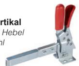
Haltebuchsen aus gehärtetem und geschliffenem Stahl. Roter Griff aus Polyurethan. Sperrhebel mit PVC-Beschichtung. Mit offenem Spannhebel und zwei Flankenscheiben oder mit massivem Spannhebel und Schweißverbindung.
