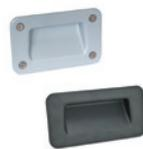
Frontmontage über Durchlöcher für flache M5-Senkkopfschrauben oder rückseitige Montage über 4 Stck. M5-Schrauben, die an den Griffkörper geschweißt sind.
