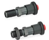
Bolzen aus gehärtetem, brüniertem Stahl. Knopf Kunststoff Thermoplast mit rotem Sicherheits-Druckknopf zum Ver- und Entriegeln. Standardausführungen: mit oder ohne Kontermutter. Bolzen Ø: 6 - 8 - 10 mm
