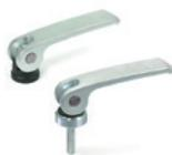
Griff Stahlguss verzinkt. Achse und Klemmelement Stahl verzinkt Gewindebohrung oder Schraube. Buchse, Stahl verzinkt mit Innenteil aus Kunststoff Thermoplast oder vollständig aus Kunststoff Thermoplast. Länge: 44 - 63 - 82 - 101 mm
