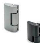
Scharnierflügel und Achsenstift aus Edelstahl 1.4301. Montage durch selbstschneidende Edelstahl-Befestigungsschrauben. Lieferbar mit koplanarem Körper, mit erhöhtem Körper, links oder rechts öffnend. Max. Drehwinkel 185° (-5° und +180° mit 0° = Koplanarität der Oberflächen). Abmessungen: 50 - 70 - 90 mm
