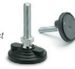
Fuß mit oder ohne rutschfeste NBR-Gummiauflage. Befestigung am Boden durch zwei um 180° versetzte Bohrungen, die durch eine Membran verschlossen sind. Mutter aus Edelstahl 1.4301 auf Anfrage.
