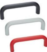
Ovalprofil, Aluminium, mit naturfarbener Oberfläche, eloxiert oder UV-beständige Kunststoffummantelung. Montage rückseitig mit Gewindefacklöchern. Achsabstände: 100 - 112 - 117 - 120 - 128 - 160 - 180 - 200 - 235 mm
