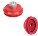
Sie werden im Bereich der Robotik in der Automobilindustrie für Oberflächen wie Blech oder Glas verwendet. Das geformte Labyrinth auf der Auflagefläche sorgt selbst bei Vorhandensein von Flüssigkeiten (Öl, Wasser) für einen starken Halt auf der zu greifenden Fläche. Der Balg ermöglicht die Anpassung auch an unregelmäßige Oberflächen oder solche mit Unebenheiten.
