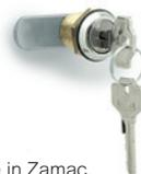
Verriegelung und Gehäuse in Zamac, Mutter aus Messing, Griff, Schließriegel und Federscheibe aus Stahl, verzinkt. Zwei Schlüssel, Messing, vernickelt, die in beiden in 180°-Stellungen abgezogen werden können. Standardausführungen: Schloss mit verschiedenen Kombinationen oder einer Kombination. Abmessungen: von 13 bis 30 mm
