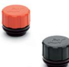
Abdeckkappe aus Kunststoff Thermoplast in orange oder schwarz. Schwarzes Verbindungsstück mit Gewinde. Dichtungsring aus Gummi NBR. Ventil: öffnet ab 10 mb oder 100 mb. Maximale Gebrauchstemperatur: 100°C. Metrische Gewinde (p 1.5): M12 - M14 - M16 - M18 - M20 - M22. GAS Gewinde: 1/4 - 3/8 - 1/2 - 3/4 - 1
