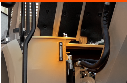
Exemple d'application du HCZ-P en SUPER-Technopolymère avec protection
