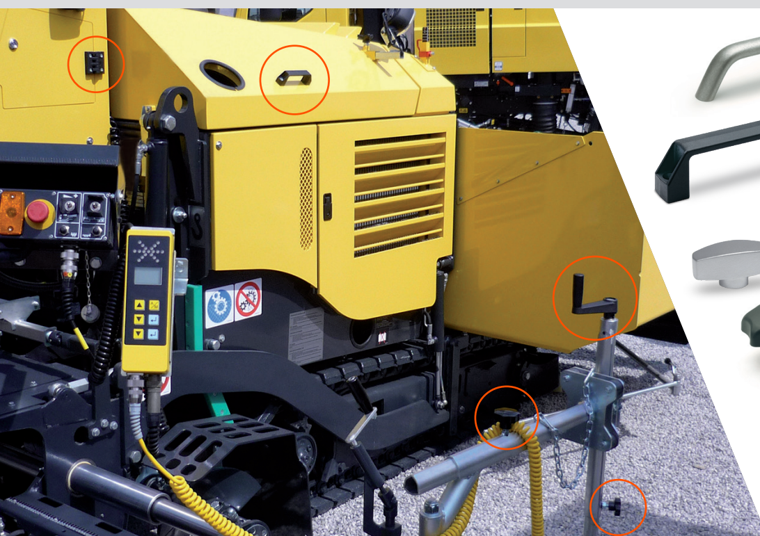
Exemple d'application de la charnière CFA. en technopolymère, poignée tiroir M.443 en technopolymère, manivelle MT., volant à lobes VC.192 en Duroplast.
