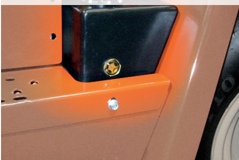
Exemple d'application de l'indicateur de niveau d'huile HFTX
