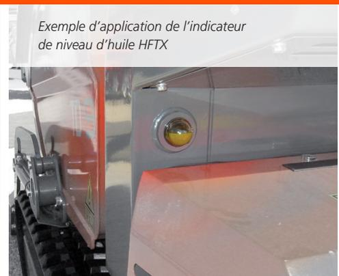
Exemple d'application de l'indicateur de niveau d'huile HFTX
