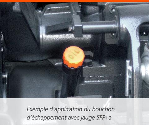
Exemple d'application du bouchon d'échappement avec jauge SFP+a
