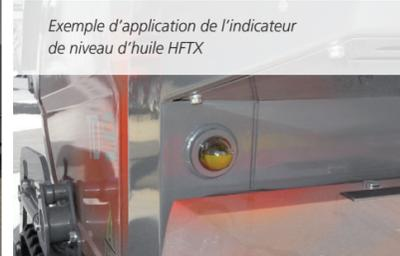
Exemple d'application de l'indicateur de niveau d'huile HFTX
