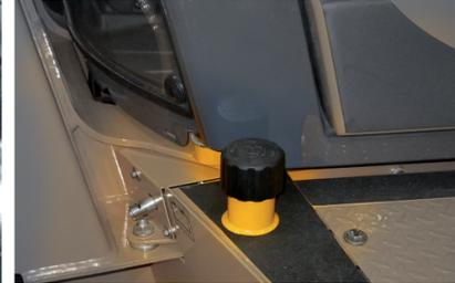
Exemple d'application du bouchon à double valve anti vandalisme SFW-VP
