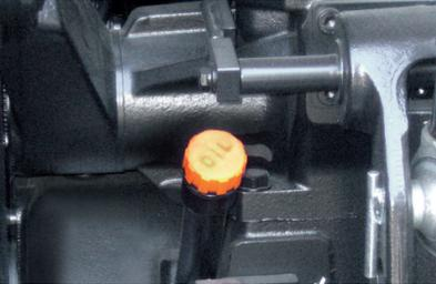
Exemple d'application du bouchon d'échappement avec jauge SFP+a
