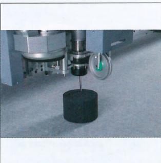
En démonstration sur le stand d'Elitron, le système de découpe automatique Kombo fonctionne avec précision et flexibilité. Facile à utiliser et très puissant, il est adapté au traitement des emballages en carton ondulé, compact ou en nid-d'abeilles ainsi que pour la mousse de polychlorure de vinyle (PVC), les films adhésifs et le vinyle. Il est équipé d'un chariot multi-outil avec lame vibrante électrique ou pneumatique, d'une électrobroche-fraise de 1 ou 3 kW,
