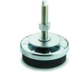
Gli elementi di livellamento antivibranti della serie LVA si compongono di base, piastra, stelo e rondella in acciaio zincato, di un disco antivibrante in gomma NBR, durezza 80 Shore A con guarnizione di tenuta in gomma sintetica NBR.
