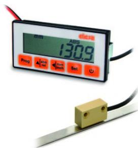
Elesa ha un vasto assortimento di componenti adatti per il settore della lavorazione dei metalli, tra i quali uno dei più interessanti è rappresentato da MPI-15, il sistema magnetico completo per la misura di spostamenti lineari e angolari che viene integrato sul macchinario facilitando e velocizzando le operazioni di taglio di materiali. I punti di forza
