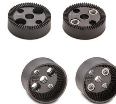
Elesa ha recentemente ampliato la linea dei Super-Tecnopolimeri con l'aggiunta degli elementi dentati di bloccaggio RDB, che, accoppiati tra loro oppure con le esecuzioni RDB-CF o RDB-CB, consentono di bloccare la posizione di due componenti che ruotano intorno ad un asse e presentano un angolo di bloccaggio regolabile con passo di 6°.
