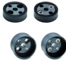
Elesa ha recentemente ampliato la linea dei super-tecnopolimeri con l'aggiunta degli elementi dentati di bloccaggio RDB che, accoppiati tra loro oppure con le esecuzioni RDB-CF o RDB-CB, consentono di bloccare la posizione di due componenti che ruotano intorno un asse e presentano un angolo di bloccaggio regolabile con passo di 6°.
