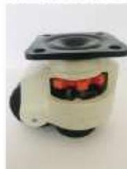
CEF Polymeres annonce la famille de roulettes FX NIVELCASTER qui combine 3 fonctions : déplacer, niveler, bloquer. Ces roulettes existent en diamètres 40/50/63/75 pour un charge jusqu'à 1000 kilos. Elles s'intègrent facilement sur les châssis en remplaçant à la fois la roulette classique et le vérin de mise à niveau. L'ergonomie est optimisée et la conception du bâti machine ainsi simplifiée. Leur construction est d'une
