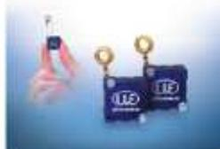
Micro-Epsilon renouvelle sa gamme de capteurs à fil tendu en proposant la famille wireSENSOR MT. Le modèle wireSENSOR MT19, de 8 g et de 19 x 19 mm seulement, est utilisé pour les mesures de déplacement et de la distance avec une plage de mesure de 40 mm. Ce capteur extrêmement compact fonctionne de manière hautement dynamique en supportant des accélérations du câble jusqu'à 60 g.
