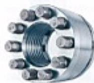
Les nouveaux écrous tensionneurs HEICO-TEC sont constitués d'un corps d'écrou équipé de vis et pistons de pression agissant sur une rondelle d'appui. Le serrage de l'écrou se fait par le vissage des vis pression, ce qui démultiplie l'effort (le couple) de vissage à appliquer. Les écrous de grand diamètre peuvent être serrés avec une simple clé dynamométrique manuelle. La mise en tension de vis se faisant par traction, la vis ne subit pas de torsion ni de flexion parasites.
