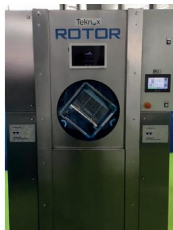
La machine est équipée de systèmes de contrôle et gestion permettant une complète personnalisation du cycle de travail, en s'adaptant simplement aux différents besoins de production, aux divers matériaux à partir desquels les pièces sont produites et aux différences de format qui, souvent, ont besoin de l'utilisation de programmes de lavage personnalisés.
