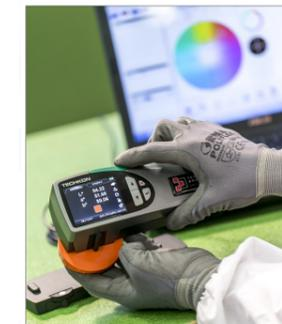
Se in produzione vengono svolti numerosi controlli dimensionali ed estetici spesso occorre tornare in laboratorio per effettuare test specifici quali il controllo del colore.
