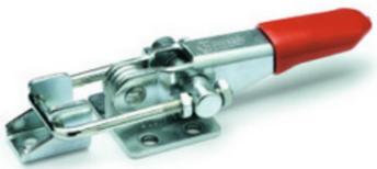
Lo speciale meccanismo a ginocchiera consente di raggiungere un ampio angolo di rotazione della leva di serraggio in fase di apertura con un breve spostamento dei componenti, così da liberare il piano di lavoro e facilitando il posizionamento e la rimozione del pezzo in lavorazione.
