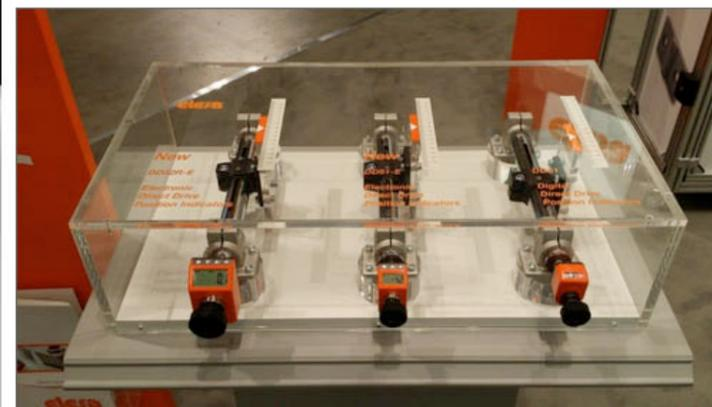
Indicatori di posizione elettronici Elesa: da sinistra il modello DD52-R, il DD51-E e il DD51.
