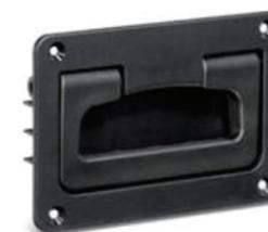
Non solo tecnopolimero: Elesa nel tempo ha inserito nella propria gamma di maniglie anche soluzioni in differenti materiali metallici. In acciaio cromato, la maniglia ripiegabile da incasso GN 425.4, montata su piastra in lega di zinco pressofusa con rivestimento in resina epossidica, di colore nero e finitura mat, che sporge dal piano di riferimento solo 3 mm. In acciaio INOX AISI 304 con finitura elettrolucidata, la maniglia a
