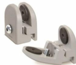
La pinza di serraggio per pannelli **Elesa PC**, realizzata in tecnopolimero color grigio con finitura mat e pastiglie in elastomero plastico sovrastampate, rappresenta l'elemento ideale per installare facilmente e senza alcuna foratura, pannelli protettivi su profilati in alluminio e acciaio di 25 mm e oltre.
