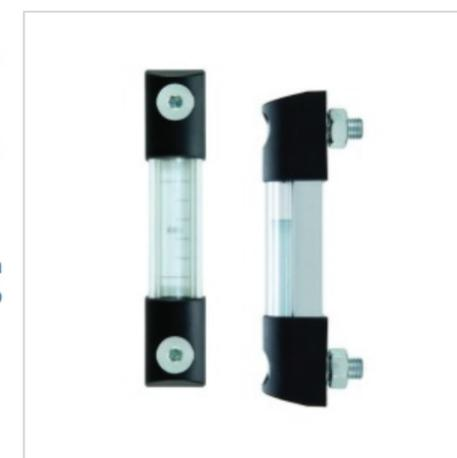
Il tubo in vetro Pyrex è il cuore dell'indicatore, grazie alle sue caratteristiche di resistenza agli sbalzi termici e agli agenti chimici. Il vetro abbinato agli speciali O-ring in gomma sintetica FKM tipo Viton e alle viti in acciaio inox Aisi 304, consente l'impiego di HCK-GL a contatto con liquidi aggressivi, come soluzioni contenenti glicole, largamente utilizzate nei sistemi di raffreddamento o in contesti applicativi a basse temperature per evitare il congelamento del liquido.
