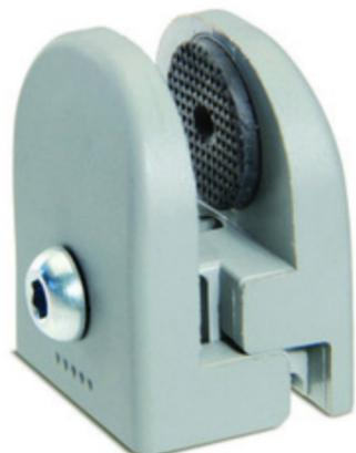
La pinza PC è composta da due corpi connessi tramite un'articolazione che garantisce l'imperdibilità di ogni elemento (brevetto Elesà) anche in caso di smontaggio del pannello, come prescritto dalla Direttiva macchine (2006/42/CE). L'adattatore APC aumenta ulteriormente la versatilità della pinza, permettendone il fissaggio su tubi tondi con spessore massimo di 2 mm.
