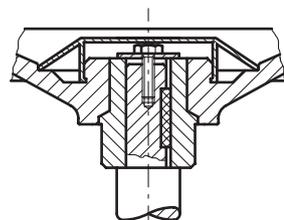
Esempio di montaggio con linguetta e vite assiale
