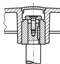
Esempio di montaggio con linguetta e vite assiale
