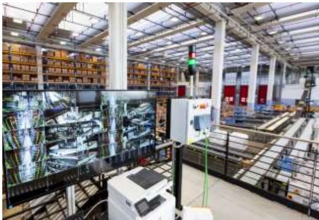
*La “Control Room” con gli schermi del sinottico sul quale sono rimandate le immagini delle telecamere di controllo montate sui singoli shuttle*
