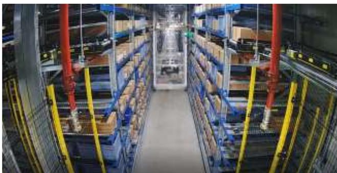
*Uno dei numerosi shuttle che operano all'interno del magazzino automatico*
