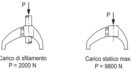
Valori rilevati con coppia di serraggio 35 Nm
