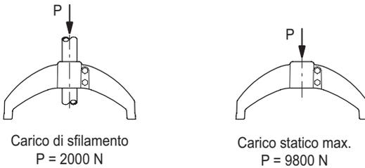
Valori rilevati con coppia di serraggio 35 Nm
