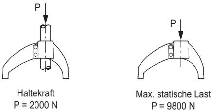
Erreichte Werte mit einem Anzugsdrehmoment von 35 Nm
