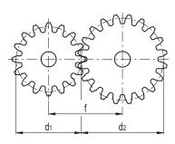
Dank der selbstschmierenden Eigenschaften von Polymeren, können grundsätzlich Thermoplast Zahnräder auch ohne Schmieröl verwendet werden. Die Verwendung von Schmierölen wird jedoch empfohlen, um Reibung und Abnutzung zu vermeiden und damit die Lebensdauer des Produkts zu verlängern. Für Zahnräder von Elesa empfehlen wir Schmierfette auf Basis von Lithium-Seifen und synthetischem Öl.
